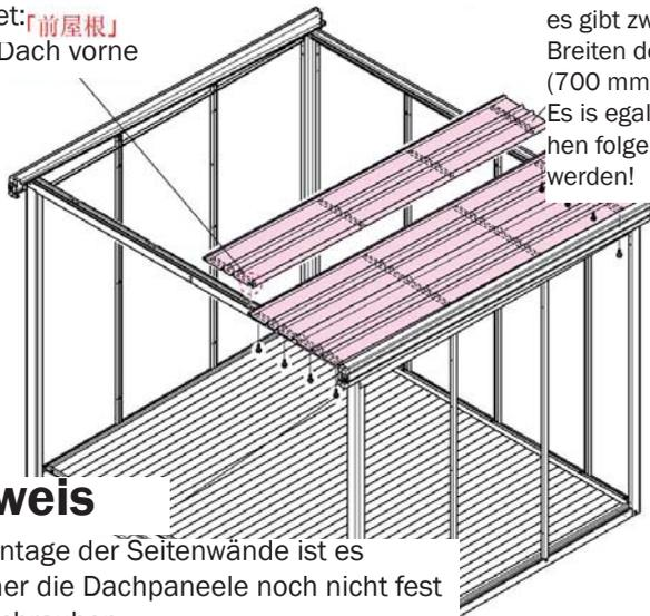
es gibt zwei verschiedene Breiten der Dachelemente (700 mm und 350 mm). Es ist egal, in welcher Reihenfolge diese aufgelegt werden!
