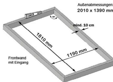
Bemaßung: Aussenkanten Punktfundament
