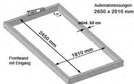
Bemaßung: Aussenkanten Punktfundament
