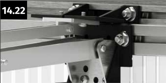
Drücken Sie die beiden Schenkel des Gestänges des Fensteröffners leicht zusammen, sodass die beiden Zapfen des Gestänges im Metallbeschlag einrasten können. Drehen Sie in dieser Position die Schrauben am Spannstück fest.
