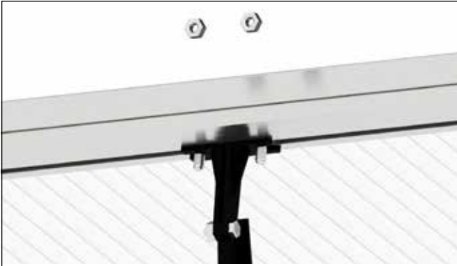
Positionieren Sie die beiden Schrauben M6x12 des unteren Scharnierprofils mittig und setzen Sie den Fensteraufsteller auf.
