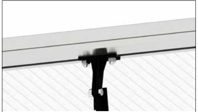
Verschrauben Sie den Fensteraufsteller mit zwei Flanschmuttern M6.
