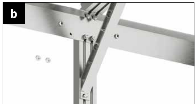
Nehmen Sie die Muttern von den in den Koppelprofilen eingesetzten Schrauben ab, positionieren Sie die Schrauben entsprechend der Löcher in der Versteifung und setzen Sie diese auf.
