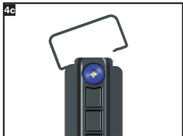
Schritt 4 - Aufclipsen der Handläufe
