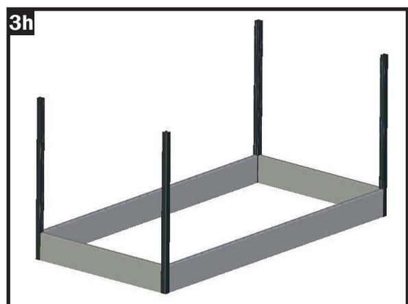
**Schritt 3 - Einsetzen der Planken in die Ecksteher**
