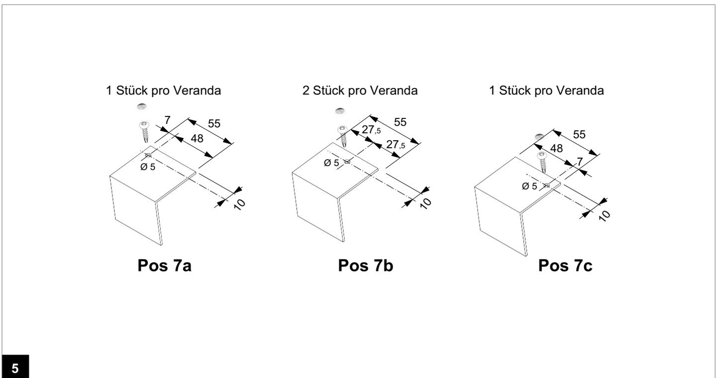
Bohren Sie die Plattenstopper vor, wie in den obigen Detailskizzen beschrieben.
