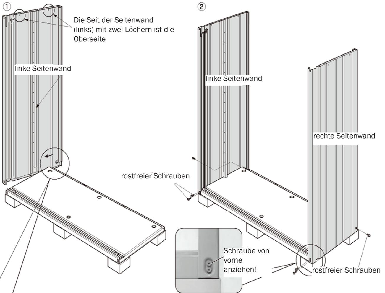
a. setzen Sie das hintere, untere Eck der Seitenwand (links) in die Nut auf der Seite der Bodenplatte
