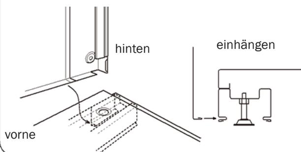
b. hängen Sie die Kralle an der hinteren Seite der Seitenwand in den Schlitz der Bodenplatte ein
