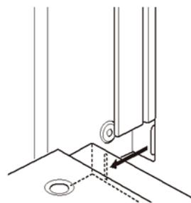
c. drehen Sie die Seitenwand (links) nach vorn und befestigen Sie sie an der Bodenplatte
