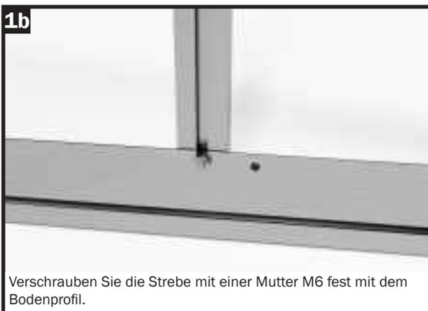
Verschrauben Sie die Strebe mit einer Mutter M6 fest mit dem Bodenprofil.
