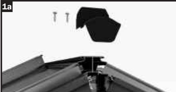
Bereiten Sie die Abdeckkappe des Firstes und selbstbohrende Schrauben 4,8 x 13 mm für die Montage vor. Wir empfehlen trotz der selbstbohrenden Schrauben mit einem Bohrer 4 mm vorzubohren
