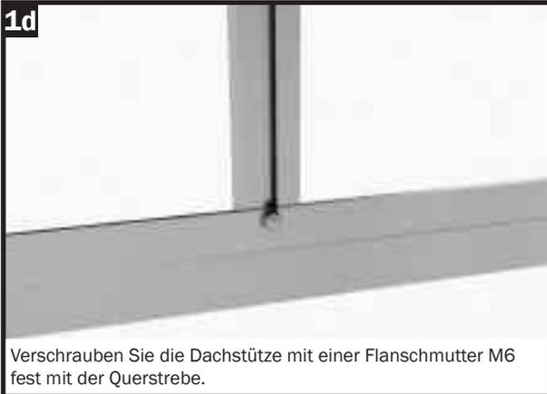
Verschrauben Sie die Dachstütze mit einer Flanschnutter M6 fest mit der Querstrebe.
