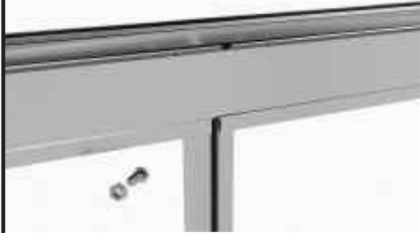
Führen Sie eine Schraube M6x12 in den Schraubkanal der Strebe.
