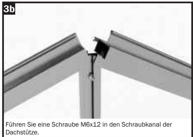
Führen Sie eine Schraube M6x12 in den Schraubkanal der Dachstütze.
