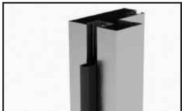
Längen Sie die Türdichtung so ab, dass diese am Ende jeweils 30 mm kürzer ist, als das Türprofil.
