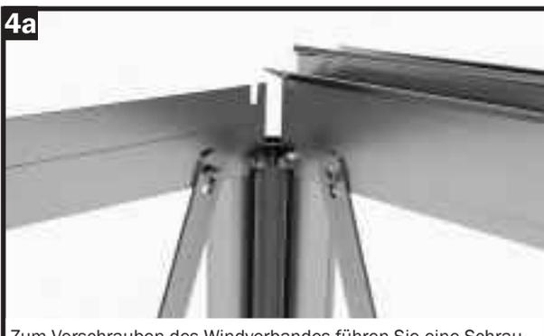
Zum Verschrauben des Windverbandes führen Sie eine Schraube M6x12 von der Außenseite durch das dafür ausgestanzte Loch der Querstrebe und setzen danach den Windverband auf.
