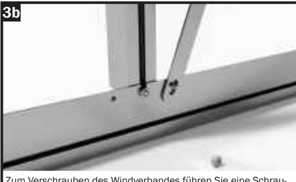
Zum Verschrauben des Windverbandes führen Sie eine Schraube M6x12 von der Außenseite durch das dafür ausgestanzte Loch des Bodenprofils und setzen danach den Windverband auf.
