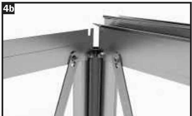
Verschrauben Sie den Windverband mit einer Flanschmutter M6 fest mit der Querstrebe.
