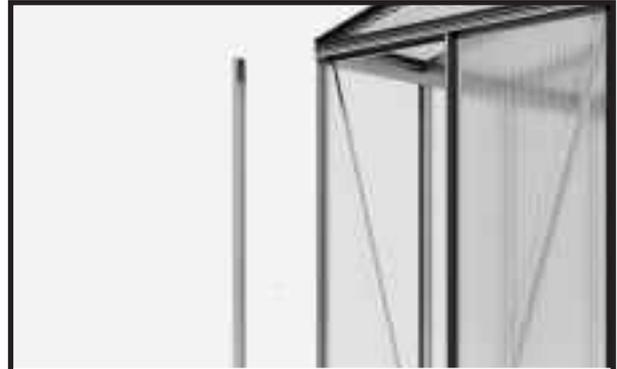
Nehmen Sie das Dichtlippenprofil so zur Hand, dass die vorweggemachte Ausparung nach oben zeigt.
