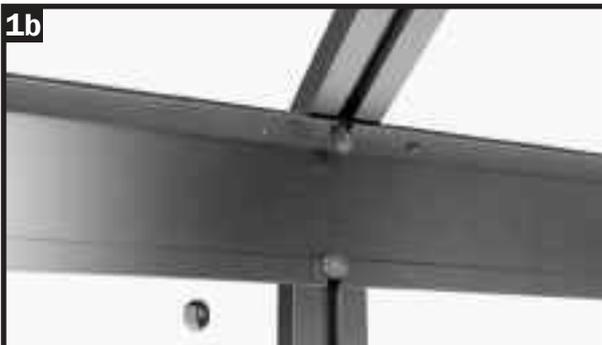
Führen Sie die Schraube M6x12 in den Schraubkanal der Dachstrebe und positionieren Sie die Schraube an der für die Verschraubung vorgesehenen Ausstanzungen der Regenrinne.
