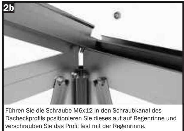
Führen Sie die Schraube M6x12 in den Schraubkanal des Dacheckprofils positionieren Sie dieses auf auf Regenrinne und verschrauben Sie das Profil fest mit der Regenrinne.
