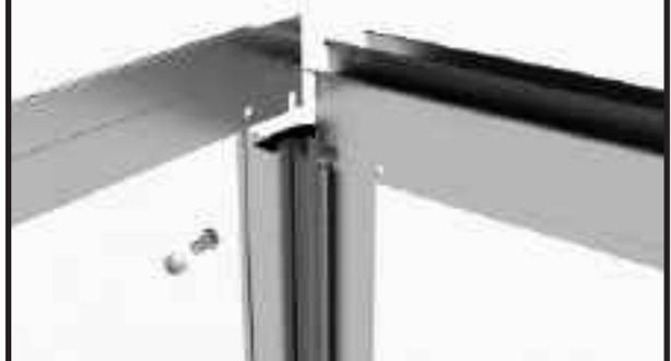
Bereiten Sie die Querstrebe, sowie eine Schraube M6x12 und eine Flanschmutter M6 vor.
