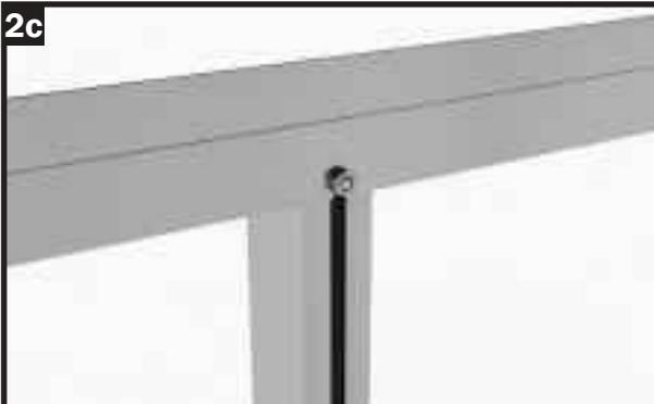
Verschrauben Sie das Türeingangsprofil mit einer Mutter M6 fest mit der Querstrebe.
