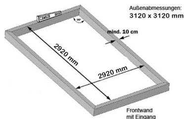
Bemaßung: Aussenkanten Punktfundament
