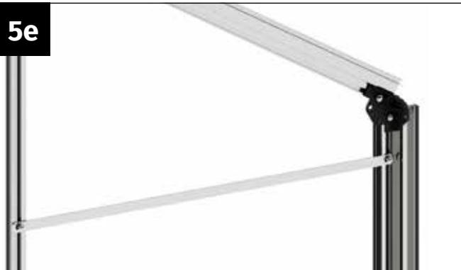
Richten Sie den Windverband so aus, dass dieser exakt waagrecht ist und verschrauben Sie diesen mit zwei Muttern M6.
