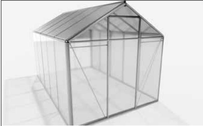
Im zweiten Schritt wird die Rückwand verglast.
