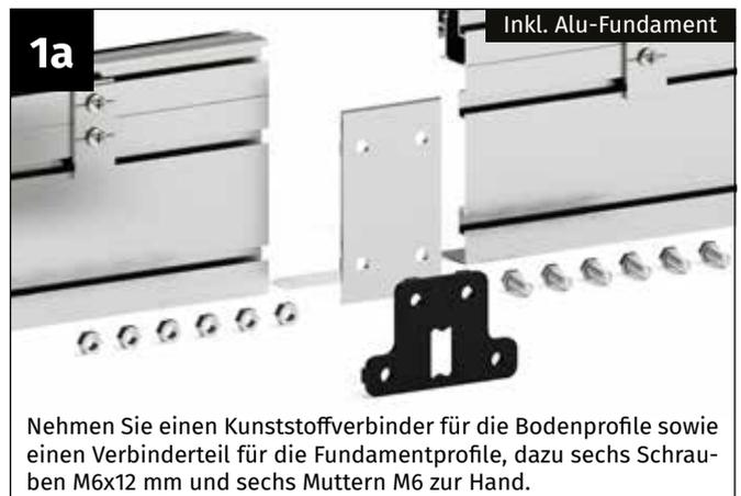
Nehmen Sie einen Kunststoffverbinder für die Bodenprofile sowie einen Verbinderteil für die Fundamentprofile, dazu sechs Schrauben M6x12 mm und sechs Muttern M6 zur Hand.
