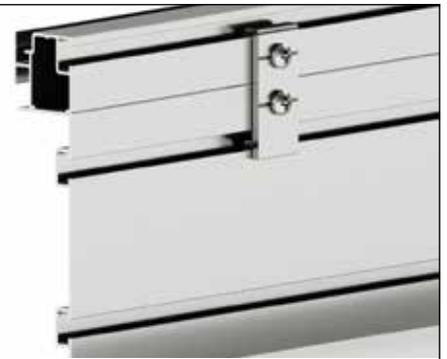
Verbinden Sie den Fundamenthaken durch das Eindrehen der Bohrschrauben 4,8x13 mm. Das Bodenprofil mit der Länge 1867 wird zusätzlich auch noch in der Mitte verschraubt.
