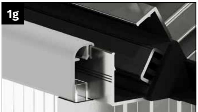
Achten Sie darauf, dass dieser über die gesamte Länge gut eingeklipst ist.
