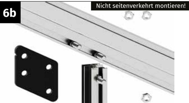
Nehmen Sie den Knoten der Querstrebe sowie eine Schraube M6x12 mm und eine Mutter M6 zur Hand. Führen Sie die Schraube in den Schraubkanal der Rückwandstrebe ein.
