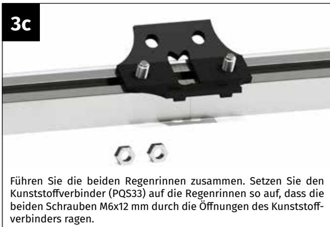
Führen Sie die beiden Regenrinnen zusammen. Setzen Sie den Kunststoffverbinder (PQS33) auf die Regenrinnen so auf, dass die beiden Schrauben M6x12 mm durch die Öffnungen des Kunststoffverbinders ragen.
