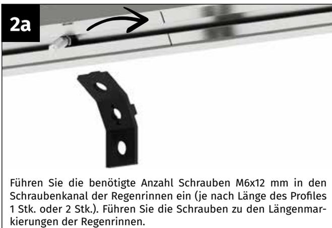
Führen Sie die benötigte Anzahl Schrauben M6x12 mm in den Schraubkanal der Regenrinnen ein (je nach Länge des Profils 1 Stk. oder 2 Stk.). Führen Sie die Schrauben zu den Längenmarkierungen der Regenrinnen.
