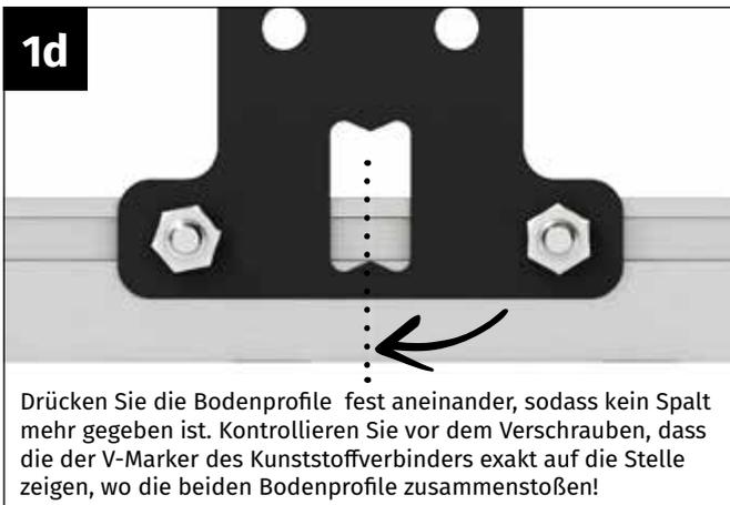
Drücken Sie die Bodenprofile fest aneinander, sodass kein Spalt mehr gegeben ist. Kontrollieren Sie vor dem Verschrauben, dass die der V-Marker des Kunststoffverbinders exakt auf die Stelle zeigen, wo die beiden Bodenprofile zusammenstoßen!
