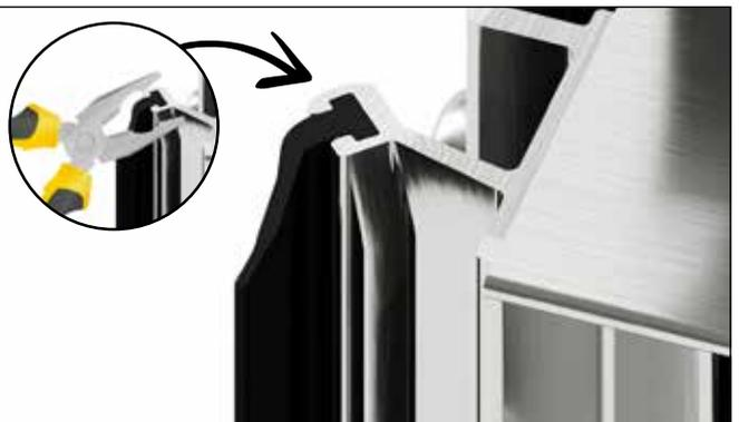
Quetschen Sie das Profil an der Oberseite mit einer Zange, damit das Verrutschen der Türdichtung verhindert wird!
