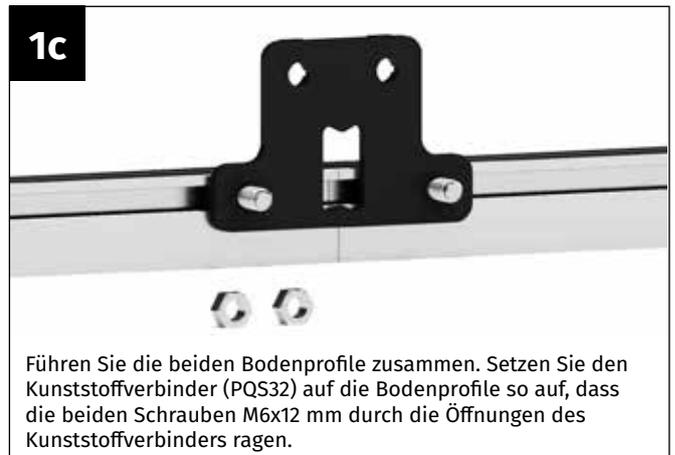
Führen Sie die beiden Bodenprofile zusammen. Setzen Sie den Kunststoffverbinder (PQS32) auf die Bodenprofile so auf, dass die beiden Schrauben M6x12 mm durch die Öffnungen des Kunststoffverbinders ragen.
