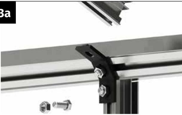
Nehmen Sie eine Dachstrebe, eine Schraube M6x12 mm und eine Mutter M6 zur Hand.
