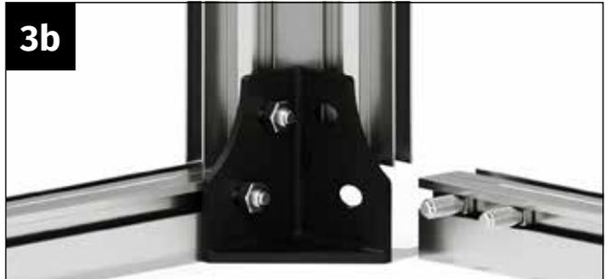
Führen Sie die Schrauben M6x12 mm in den Schraubenkanal des Bodenprofils ein.
