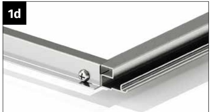
Verschrauben Sie die beiden Teile mit der Blechschraube 4,2x22 mm.
