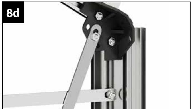
Verschrauben Sie den Windverband mit einer Mutter M6 mit dem Eckverbinder.
