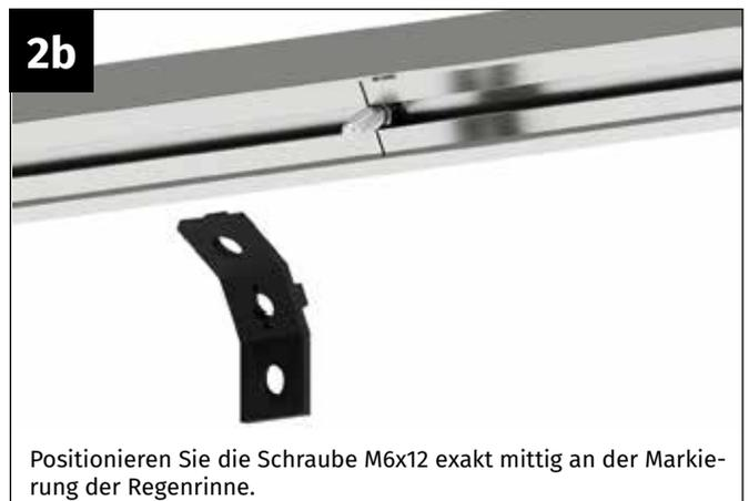
Positionieren Sie die Schraube M6x12 exakt mittig an der Markierung der Regenrinne.
