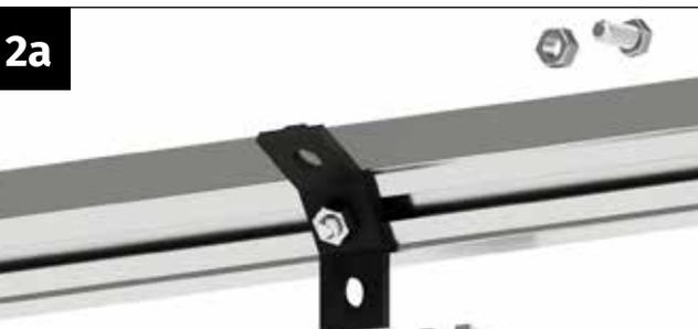
Nehmen Sie eine Schraube M6x12 mm und eine Mutter M6 zur Hand.
