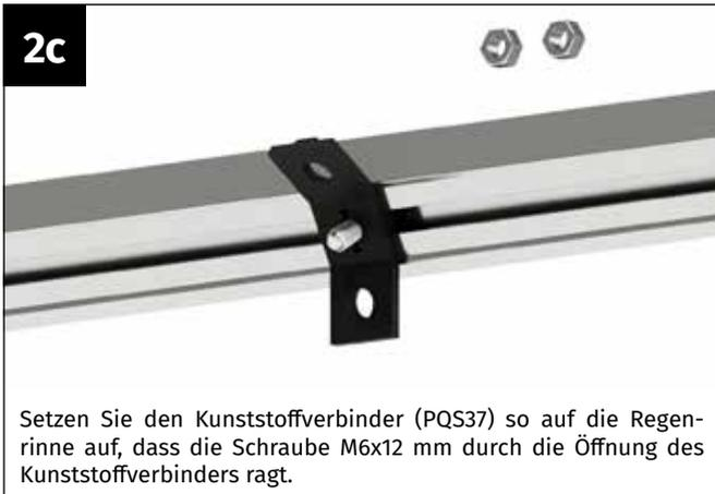
Setzen Sie den Kunststoffverbinder (PQS37) so auf die Regenrinne auf, dass die Schraube M6x12 mm durch die Öffnung des Kunststoffverbinders ragt.
