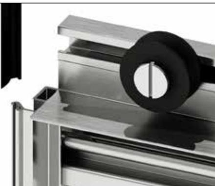
Längen Sie die Türdichtung auf die Länge des seitlichen Türprofils ab und führen Sie diese in die dafür vorgesehene Nut ein.
