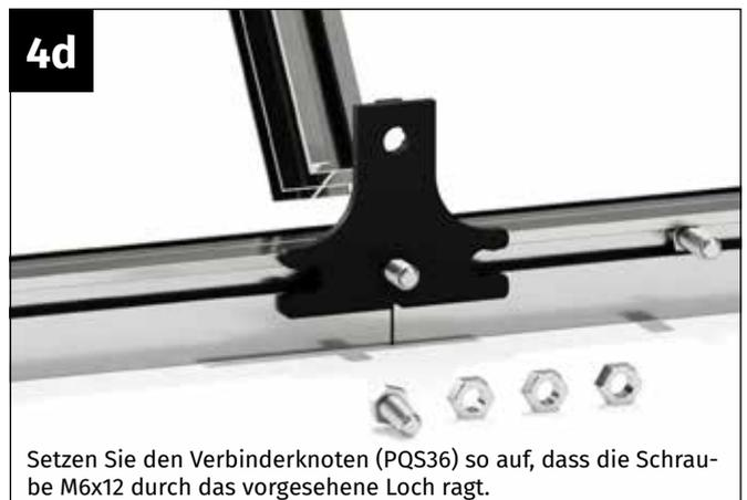
Setzen Sie den Verbinderknoten (PQS36) so auf, dass die Schraube M6x12 durch das vorgesehene Loch ragt.
