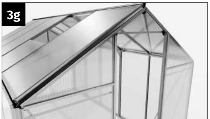
Setzen Sie die Platten auf die H-Profile auf.
