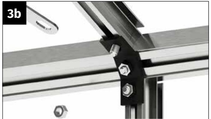
Lösen Sie die Mutter mit welcher die Dachstrebe mit dem Verbinderknoten verschraubt wurde.
