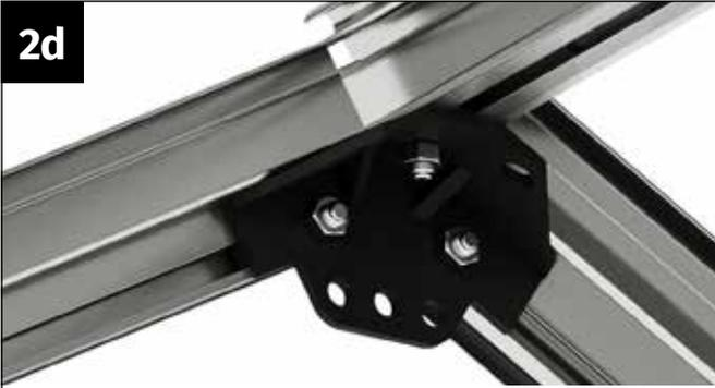
Drücken Sie das Firstprofil so weit nach außen, dass dieses gegen den Anschlag des Kunststoffverbinders stößt. Verschrauben Sie das Firstprofil fest mit einer Mutter M6.
