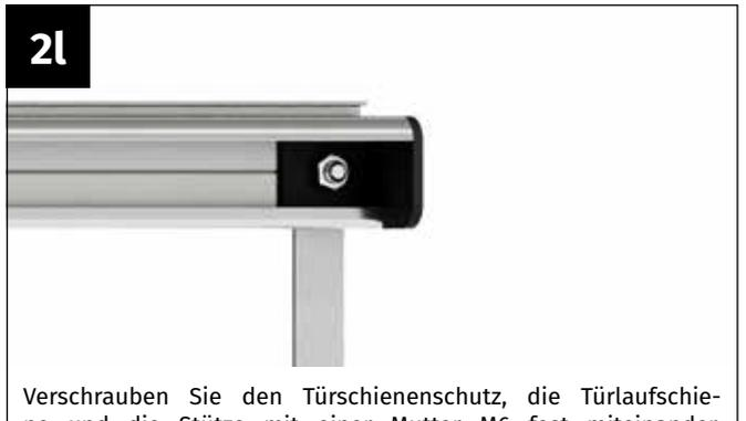
Verschrauben Sie den Türschienschutz, die Türlaufschiene und die Stütze mit einer Mutter M6 fest miteinander. **Achten Sie darauf, dass Sie die Stütze im Lot ausgerichtet ist. Ansonsten richten Sie die Türlaufschiene entsprechend aus!**
