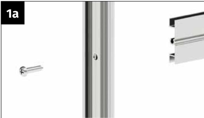
Nehmen Sie das Türprofil seitlich, die Türspresse sowie eine Blechschraube 4,2x22 mm zur Hand.
