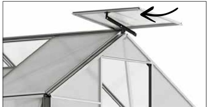
Führen Sie den Fensterflügel in das Firstprofil ein. Es empfiehlt sich, den Scharnierkegel des Fensterflügels mit etwas Öl (**nicht im Lieferumfang**) zu versehen.
