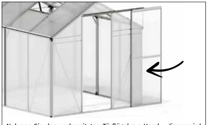
Nehmen Sie den vorbereiteten Türflügel zur Hand - dieser wird nun in der Frontwand eingesetzt.
