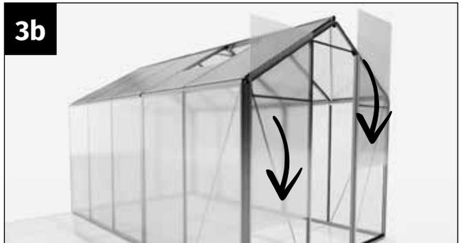
Nehmen Sie die beiden Stegplatte der Frontwand und schieben Sie diese von oben in die Nuten des Seiteneckprofils und des Tür-eingangprofils ein
