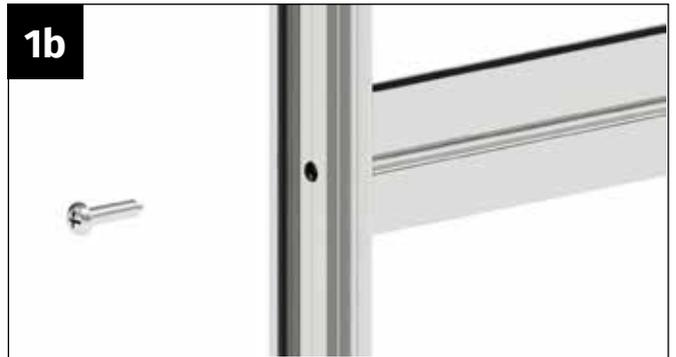
Positionieren Sie die Türspresse so am Türprofil seitlich, dass das ausgestanzte mittlere Loch genau über dem Schraubkegel der Türspresse liegt.
