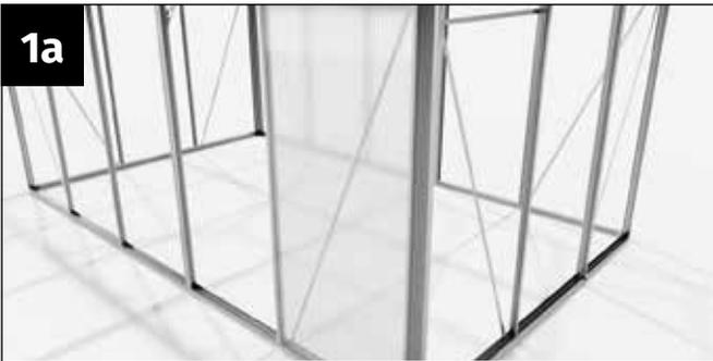
Nehmen Sie eine Stegplatte der Seitenwand und setzen Sie diese in das vorderste Feld der Seitenwand ein. **Es kann dafür notwendig sein, den Windverband an der Innenseite nochmals zu lockern**, um das Gewächshaus exakt im Lot ausrichten zu können.
