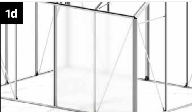
Verglasen Sie das nächste Feld der Seitenwand mit einer weiteren Stegplatte.
