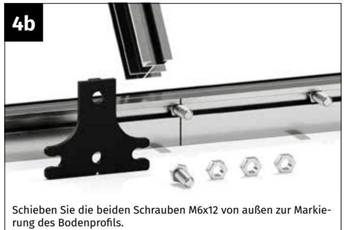
Schieben Sie die beiden Schrauben M6x12 von außen zur Markierung des Bodenprofils.
