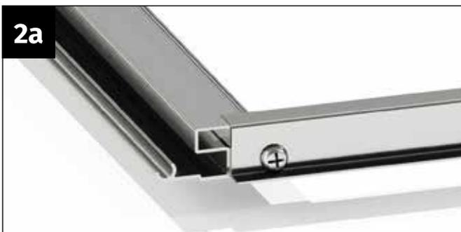
Stecken Sie auf der zweiten Seite des Scharnierprofils das zweite seitliche Fensterprofil auf und verschrauben Sie auch dieses mit einer Blechschraube 4,2x22 mm.
