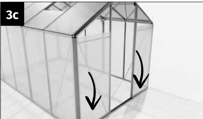
Drücken Sie die Stegplatten fest nach unten, sodass die Platten in die Nut des Bodenprofils eingeschoben wird.
