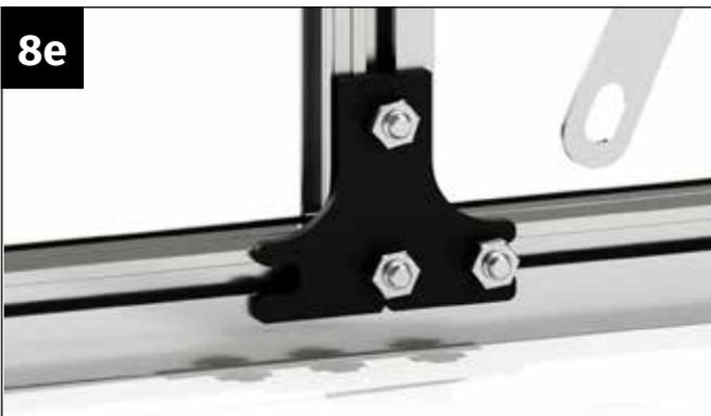
Führen Sie den unteren Teil des Windverbandes zum Verbinderknoten des Türeingangsprofils und entfernen Sie die Mutter M6.
