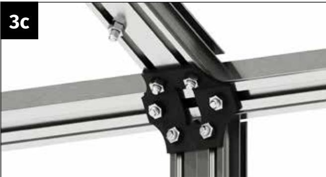
Verschrauben Sie das Koppelprofil mit zwei Muttern M6 fest mit dem Verbinderknoten. Sichern Sie die übrige Schraube des linken Schraubkanals mit einer Mutter vor dem Verrutschen.
