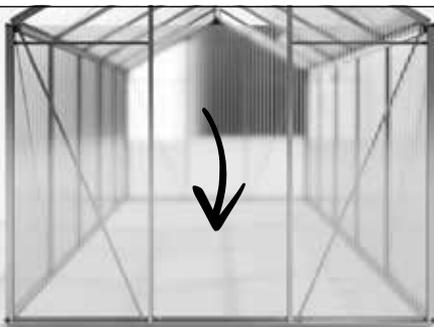
Führen Sie die dritte Stegplatten von oben in das jeweils ausgeformte „U“ der Seiteneckprofile und der Rückwandstreben ein. Drücken Sie die drei Stegplatten fest nach unten, sodass die Platten in die Nut des Bodenprofils eingeschoben werden.
