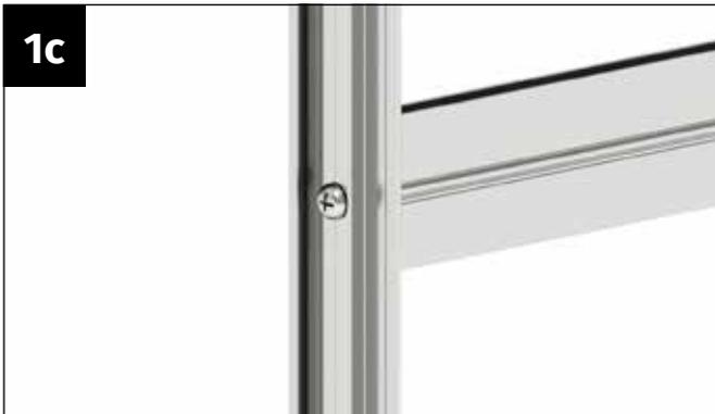
Verschrauben Sie das seitliche Türprofil mit der Blechschraube 4,2x22 mm fest mit der Türspresse.
