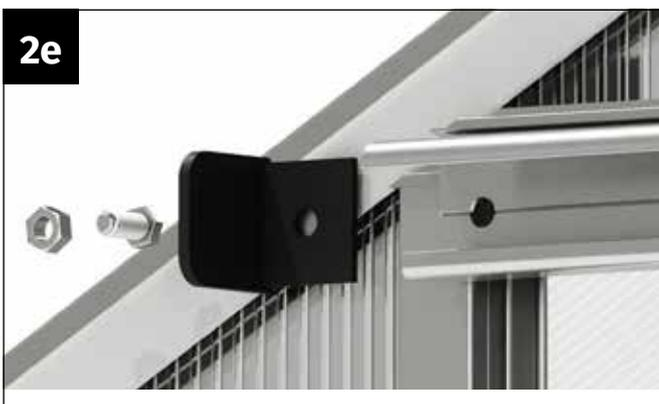
Nehmen Sie einen Türschienschutz, eine Schraube M6x12 mm und eine Mutter M6 zur Hand.
