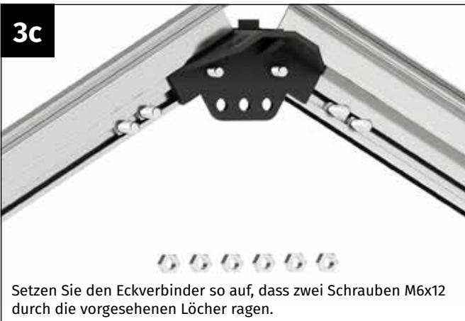
Setzen Sie den Eckverbinder so auf, dass zwei Schrauben M6x12 durch die vorgesehenen Löcher ragen.
