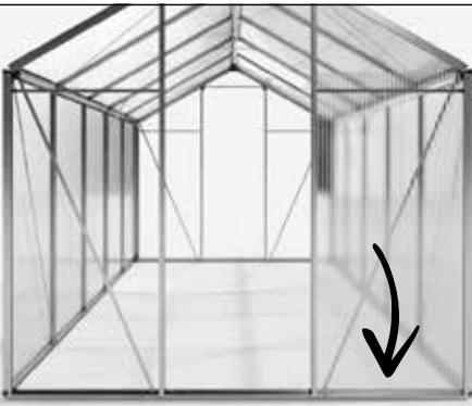
Drücken Sie die Stegplatte fest nach unten, sodass die Platte in die Nut des Bodenprofils eingeschoben wird.
