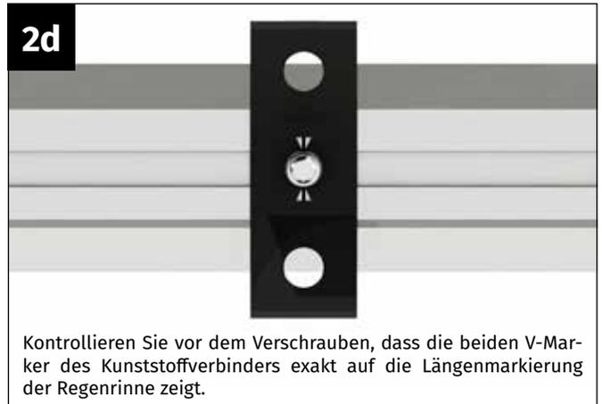
Kontrollieren Sie vor dem Verschrauben, dass die beiden V-Marker des Kunststoffverbinders exakt auf die Längenmarkierung der Regenrinne zeigt.
