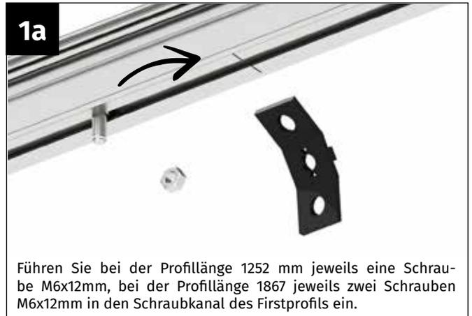
Führen Sie bei der Profillänge 1252 mm jeweils eine Schraube M6x12mm, bei der Profillänge 1867 jeweils zwei Schrauben M6x12mm in den Schraubkanal des Firstprofils ein.
