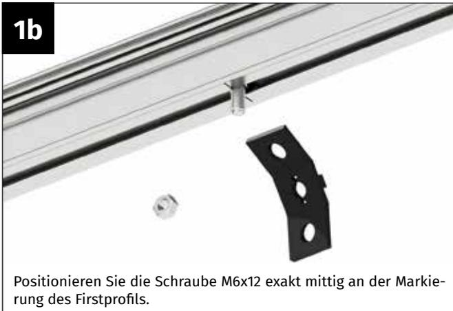
Positionieren Sie die Schraube M6x12 exakt mittig an der Markierung des Firstprofils.
