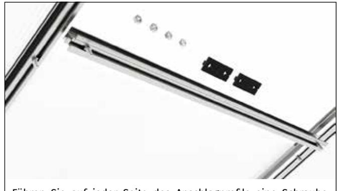
Führen Sie auf jeder Seite des Anschlagprofils eine Schraube M6x12 mm in den Schraubkanal ein. Setzen Sie je eine Rhombusschraube in den Schraubkanal der Dachstrebe ein.
