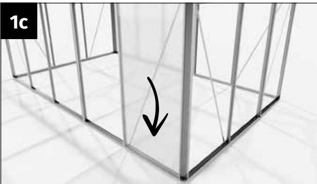
Drücken Sie die Stegplatte fest nach unten, sodass die Platte in die Nut des Bodenprofils eingeschoben wird.
