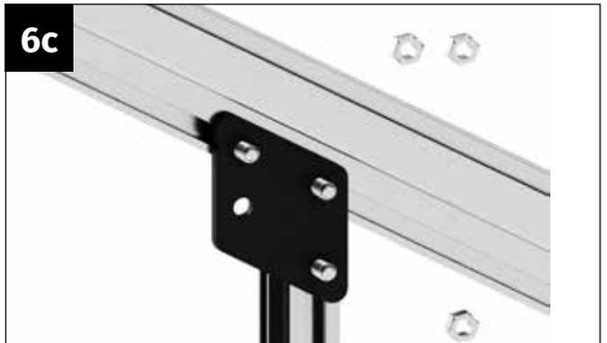
Setzen Sie den Knoten der Querstrebe so auf, dass die drei Schrauben durch die Löcher des Knotens ragen.
