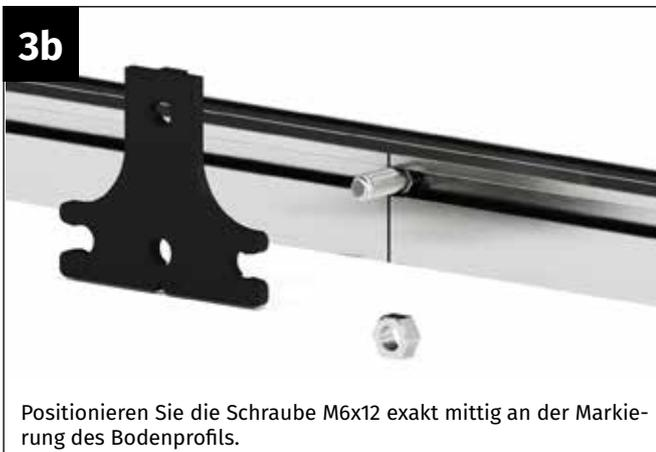
Positionieren Sie die Schraube M6x12 exakt mittig an der Markierung des Bodenprofils.
