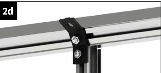
Verschrauben Sie die Strebe mit einer Mutter M6 fest mit dem Kunststoffverbinder.
