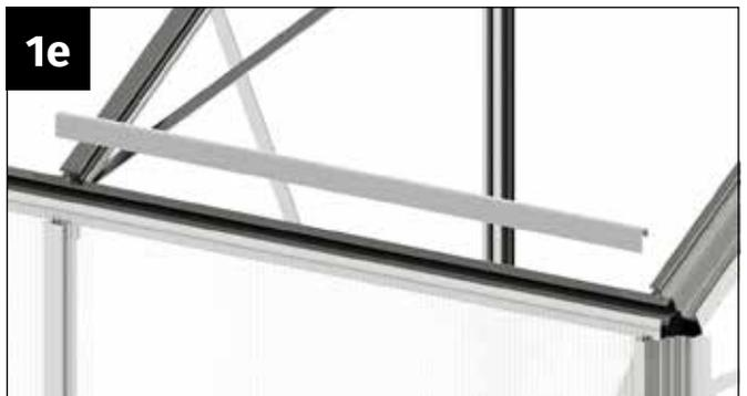
Nehmen Sie einen Verglasungsclip zur Hand - längen Sie diesen ggf. auf die richtige Länge ab. Verwenden Sie dafür eine feinzahnlige Säge.
