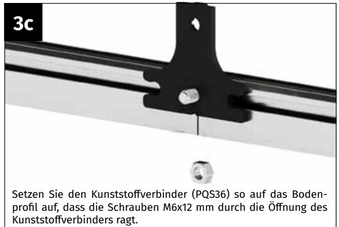
Setzen Sie den Kunststoffverbinder (PQS36) so auf das Bodenprofil auf, dass die Schraube M6x12 mm durch die Öffnung des Kunststoffverbinders ragt.
