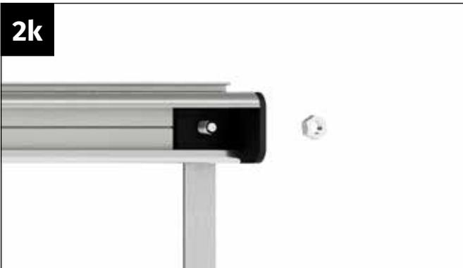
Stecken Sie die Schraube M6x12 mm von hinten durch das Loch der Stütze, der Türlaufschiene und des Türschienschutzes.
