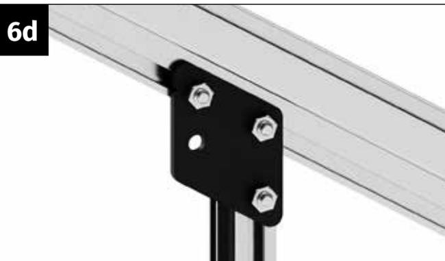
Verschrauben Sie den Knoten der Querstrebe mit Muttern M6 fest mit dem Dacheck- und dem Türeingangsprofil.
