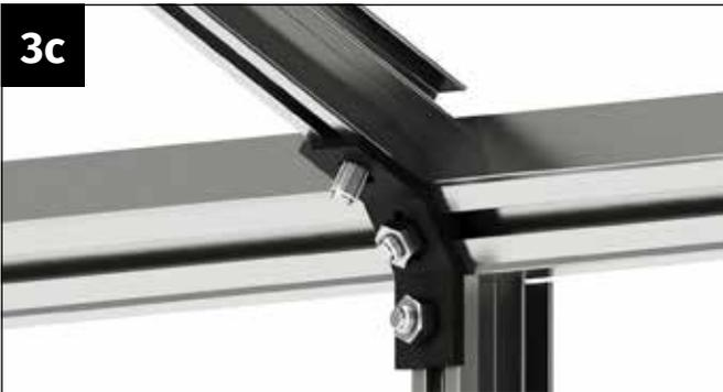
Setzen Sie die Dachstrebe auf den Kunststoffverbinder auf. Positionieren Sie die Schraube M6x12 mm im Loch des Kunststoffverbinders.
