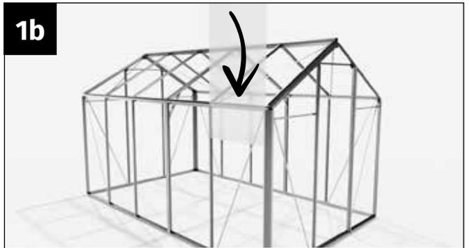
Führen Sie die Stegplatte von oben vor der Regenrinne in das jeweils ausgeformte „U“ des Seiteneckprofils und der Seitenwandstrebe ein.
