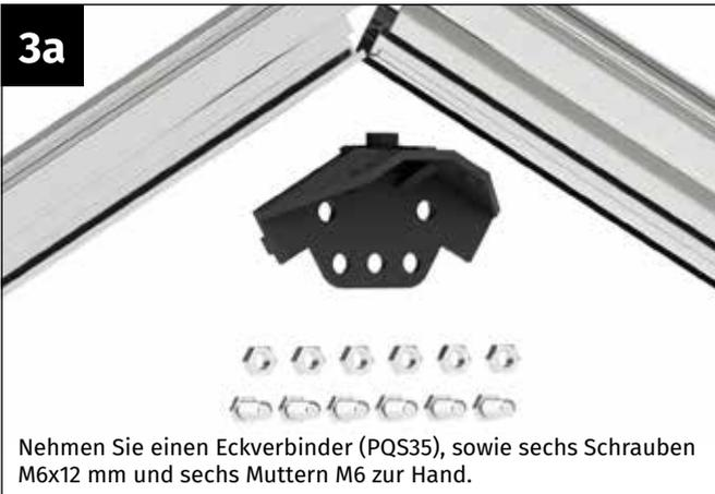
Nehmen Sie einen Eckverbinder (PQS35), sowie sechs Schrauben M6x12 mm und sechs Muttern M6 zur Hand.
