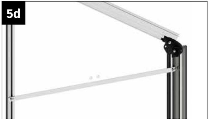
Setzen Sie den Windverband so auf die beiden Schrauben M6x12 mm, dass diese durch die Löcher des Windverbandes ragen.
