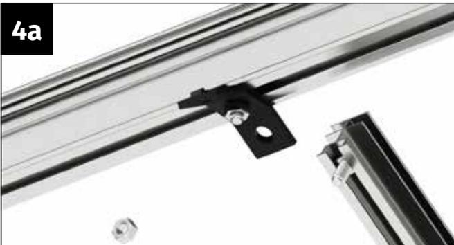
Nehmen Sie eine Schraube M6x12 mm und eine Mutter M6 zur Hand. Führen Sie die Schraube M6x12 mm an der Oberseite in den Schraubkanal der Dachstrebe ein.
