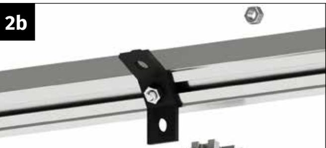
Führen Sie eine Schraube M6x12 mm an der Oberseite in den Schraubkanal der Strebe ein.
