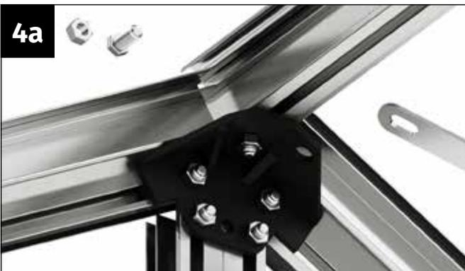
Nehmen Sie eine Schraube M6x12 mm und eine Mutter M6 zur Hand.
