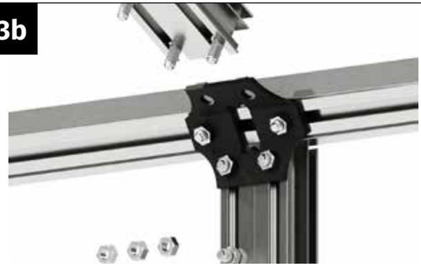
Führen Sie zwei Schrauben M6x12 mm in den linken und eine Schraube in den rechten Schraubkanal des Koppelprofils ein.
