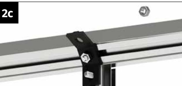
Setzen Sie die Strebe der Seitenwand auf den Kunststoffverbinder auf. Positionieren Sie die Schraube M6x12 mm im Loch des Kunststoffverbinders.
