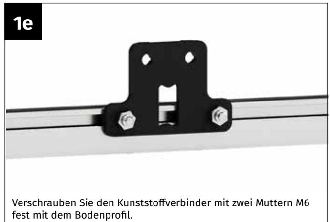
Verschrauben Sie den Kunststoffverbinder mit zwei Muttern M6 fest mit dem Bodenprofil.
