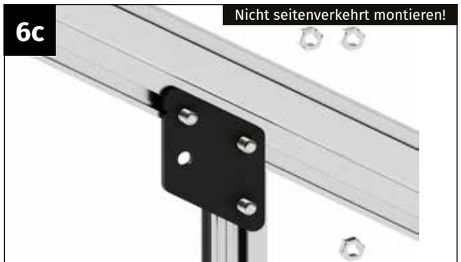
Setzen Sie den Knoten der Querstrebe, dass die drei Schrauben durch die Löcher des Knotens ragen.
