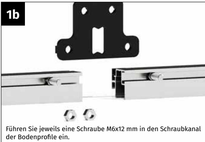
Führen Sie jeweils eine Schraube M6x12 mm in den Schraubkanal der Bodenprofile ein.
