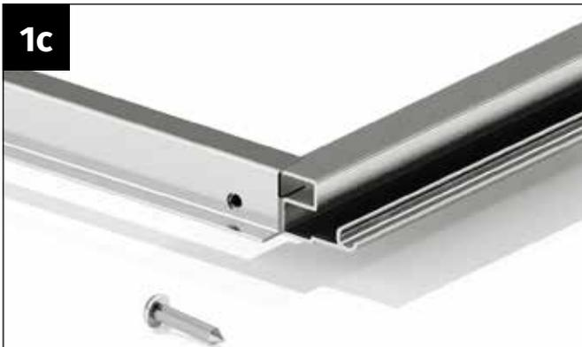
Stecken Sie das seittl. Fensterprofil auf das Scharnierprofil auf.
