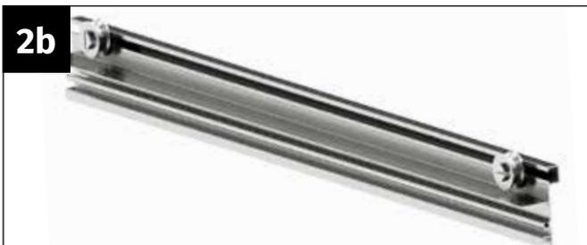
Führen Sie die Mutter in den Schraubkanal des Türrollenprofils ein. Stecken Sie den Achsbolzen in die Türrolle. Verschrauben Sie den Achsbolzen mit der Mutter. **Wir empfehlen die Türrolle jeweils etwa 30 mm vom Ende des Türrollenprofils zu positionieren und nicht zu fest anzuziehen (muss drehen können).** Wiederholen Sie den Vorgang an der zweiten Seite des Türrollenprofils.
