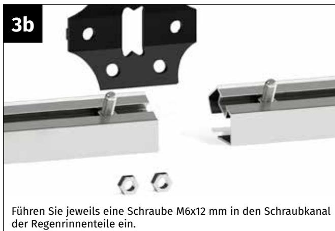
Führen Sie jeweils eine Schraube M6x12 mm in den Schraubkanal der Regenrinnenteile ein.
