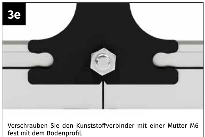
Verschrauben Sie den Kunststoffverbinder mit einer Mutter M6 fest mit dem Bodenprofil.
