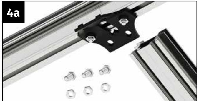
**ACHTUNG:** An der Oberseite des Koppelprofils benötigen Sie jeweils drei Schrauben M6x12 mm sowie drei Muttern M6.
