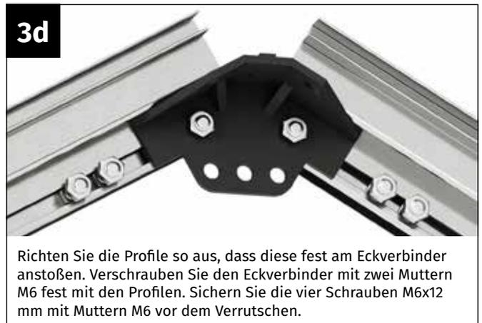
Richten Sie die Profile so aus, dass diese fest am Eckverbinder anstoßen. Verschrauben Sie den Eckverbinder mit zwei Muttern M6 fest mit den Profilen. Sichern Sie die vier Schrauben M6x12 mm mit Muttern M6 vor dem Verrutschen.
