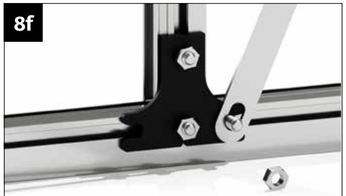
Setzen Sie den Windverband auf die Schraube M6x12 mm auf, sodass die Schraube durch das Loch des Windverbandes ragt.
