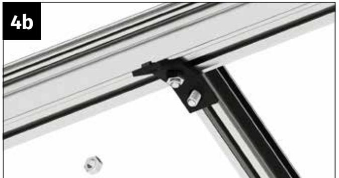
Setzen Sie die Dachstrebe auf den Kunststoffverbinder auf. Positionieren Sie die Schraube M6x12 mm im Loch des Kunststoffverbinders.
