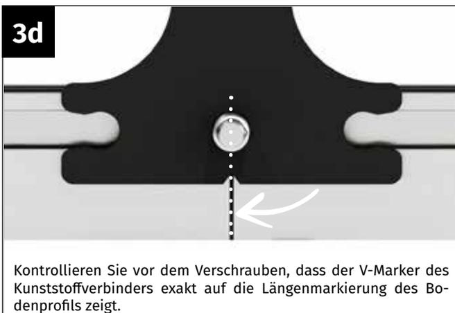
Kontrollieren Sie vor dem Verschrauben, dass der V-Marker des Kunststoffverbinders exakt auf die Längenmarkierung des Bodenprofils zeigt.
