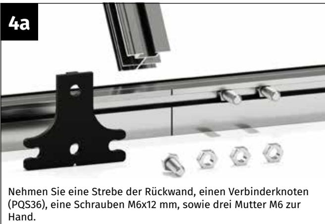
Nehmen Sie eine Strebe der Rückwand, einen Verbinderknoten (PQS36), eine Schrauben M6x12 mm, sowie drei Muttern M6 zur Hand.
