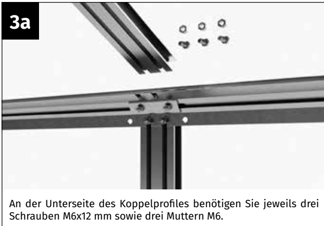
Führen Sie zwei Schrauben M6x12 mm in den linken und eine Schraube in den rechten Schraubkanal des Koppelprofils ein. Legen Sie das Koppelprofil auf und führen Sie zwei Schrauben in die Stanzungen der Regenrinne ein.
