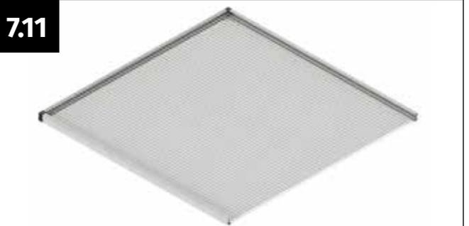
Drücken Sie die Stegplatte fest in den Rahmen ein, sodass sie im ausgeformten „U“ des Scharnierprofils fest gegen den Anschlag stößt.
