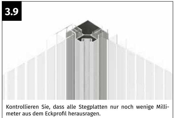
Kontrollieren Sie, dass alle Stegplatten nur noch wenige Milli-meter aus dem Eckprofil herausragen.
