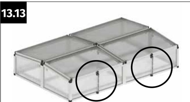
Als nächstes werden die Fensteraufsteller zusammengebaut und am Fensterflügel montiert.
