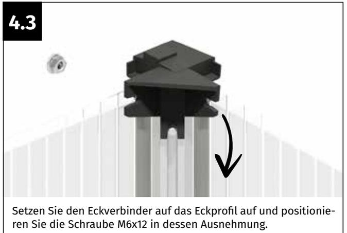
Setzen Sie den Eckverbinder auf das Eckprofil auf und positionieren Sie die Schraube M6x12 in dessen Ausnehmung.
