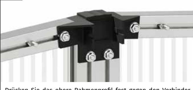
Drücken Sie das obere Rahmenprofil fest gegen den Verbinder und verschrauben Sie das Rahmenprofil jeweils fest mit einer Flanschmutter M6.
