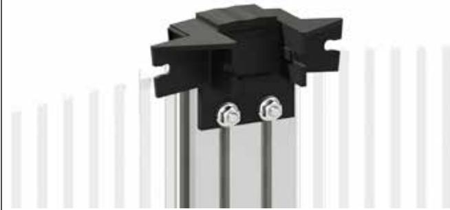
Drücken Sie den Verbinder fest nach unten und verschrauben Sie das Mittelprofil fest mit den Flanschmutter M6.
