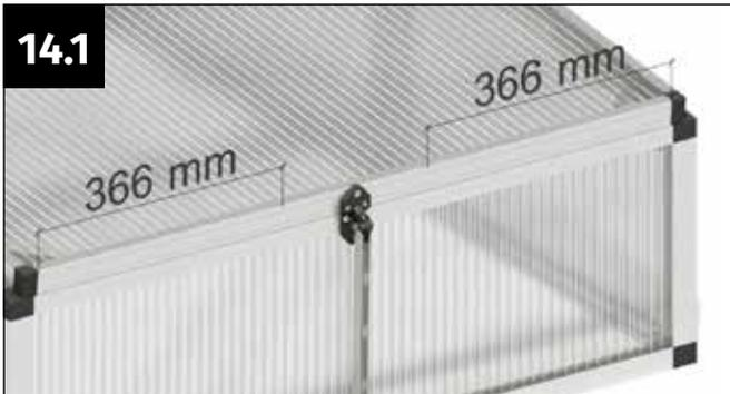
Markieren Sie die Position der Bohrlöcher, indem Sie von jeder Seite des Fensterprofils 366 mm von der Außenseite nach innen messen.
