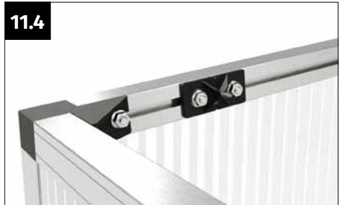
Verschrauben Sie den Einhängeteil mit den Flanschmuttern M6.
