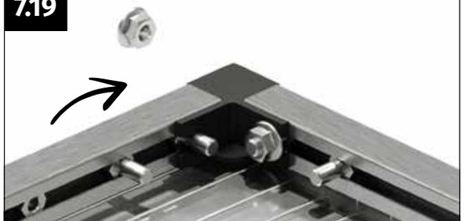
Stecken Sie das vordere Fensterprofil mit den Kunststoffecken auf die seitlichen Fensterprofile auf. Führen Sie eine Schraube M6x12 mm in die Ausnehmung der Kunststoffecke ein.
