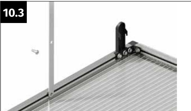
Positionieren Sie das äußere Loch des Fensteraufstellers exakt vor der Mutter M6.
