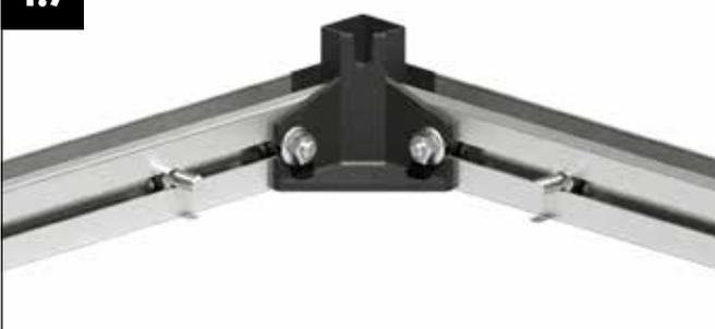
Kontrollieren Sie, dass die Bodenprofile fest gegen den unteren Eckwinkel stoßen, und verschrauben Sie die Bodenprofile fest mit den Flanschmutter M6.
