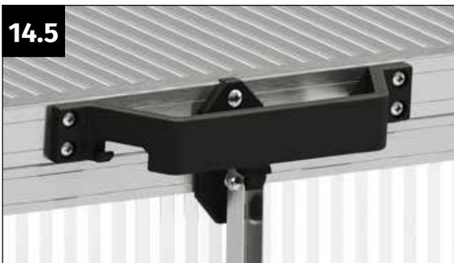
Verschrauben Sie den Fenstergriff mit den vier selbstbohrenden Blechschrauben 4,8x13 mm.
