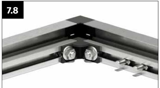
Drücken Sie das Scharnierprofil fest gegen die Kunststoffecke und verschrauben Sie dieses fest mit der Flanschmutter M6.
