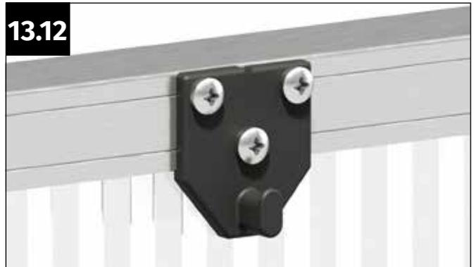
Verschrauben Sie die Aufstellerfixierung mit den drei selbstbohrenden Blechschrauben 4,8x13 mm.
