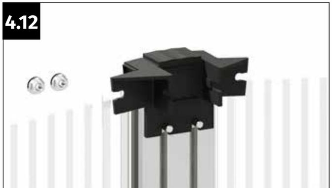
Setzen Sie den Verbinder auf das Mittelprofil und positionieren Sie die Schrauben M6x12 in dessen Ausnehmungen.
