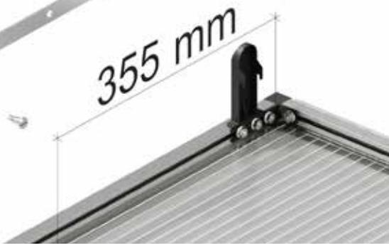
Bringen Sie an der Rückseite des Fensterflügels am seitlichen Fensterprofil, gemessen von der Ecke des Fensters, eine Markierung nach 355 mm an.
