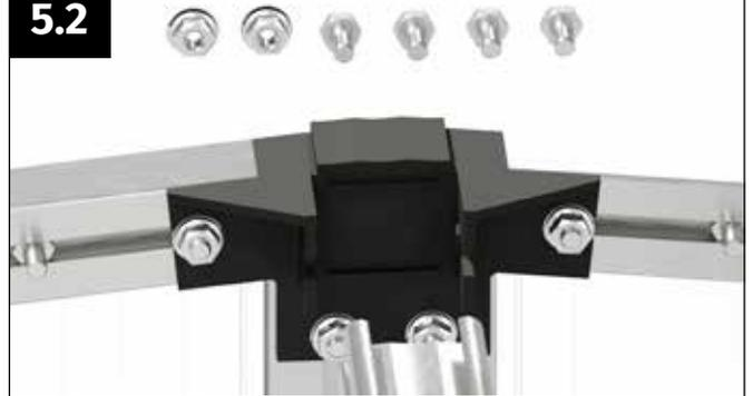
Nehmen Sie das Firstprofil sowie vier Schrauben M6x12 mm und zwei Flanschmuttern zur Hand.
