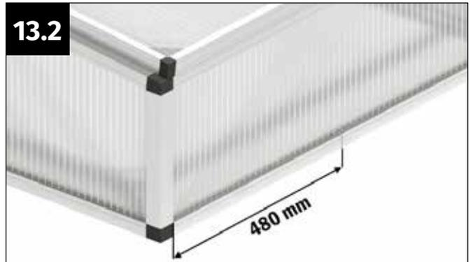
Markieren Sie die Position des unteren Rasthakens, indem Sie von jeder Seite des unteren Profils 480 mm nach innen messen.
