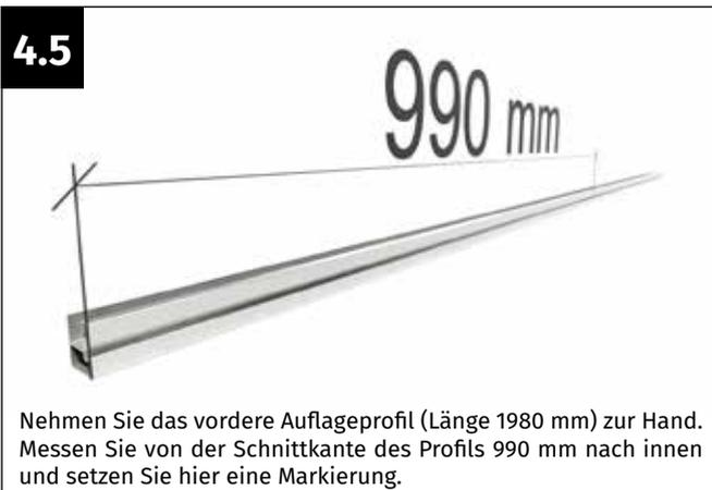
Nehmen Sie das vordere Auflageprofil (Länge 1980 mm) zur Hand. Messen Sie von der Schnittkante des Profils 990 mm nach innen und setzen Sie hier eine Markierung.
