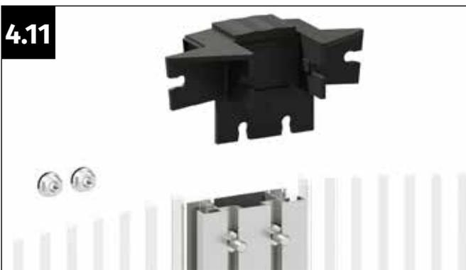
Führen Sie jeweils eine Schraube M6x12 mm in jeden der beiden Schraubkanäle des Mittelprofils ein.
