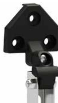
Verschrauben Sie die Teile mit der selbstsichernden Mutter M4. Ziehen Sie die Schraube behutsam fest, sodass der Aufsteller noch beweglich bleibt.
