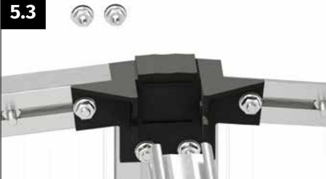
Führen Sie jeweils zwei Schrauben M6x12 mm in jeden der beiden Schraubkanäle des Firstprofils ein.
