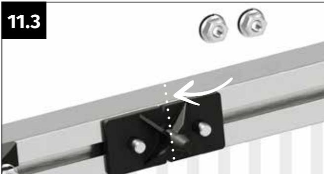
Setzen Sie den Einhängeteil auf die Schrauben auf. Positionieren Sie den Einhängeteil so, dass die V-Nuten am Einhängeteil genau an der Markierung positioniert sind.
