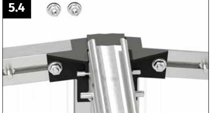
Setzen Sie das Firstprofil auf den Verbinder auf und positionieren Sie je eine Schraube M6x12 in dessen Ausnehmungen.
