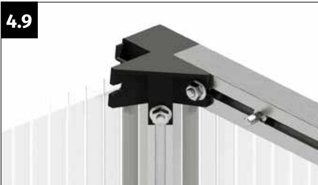
Verschrauben Sie das vordere Auflageprofil fest mit der Flanschmutter M6.
