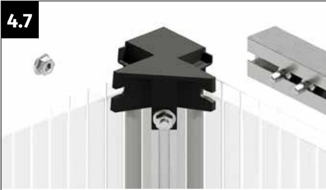
Führen Sie die Schrauben M6x12 mm in den Schraubkanal des vorderen Auflageprofils ein.
