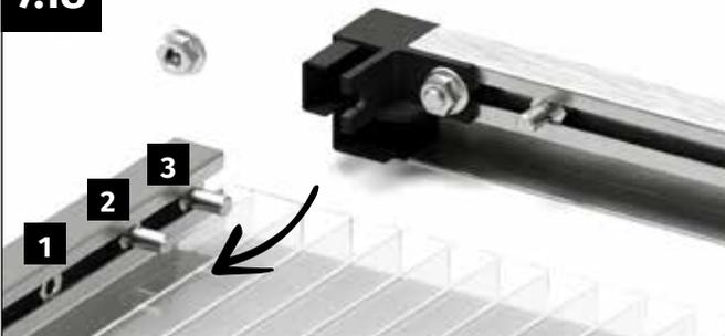
Führen Sie an jeder Seite zuerst die Mutter M6 und dann die beiden Schrauben M6x12 mm in den Schraubenkanal der seitlichen Fensterprofile ein. **Bitte beachten Sie unbedingt die Reihenfolge!**
