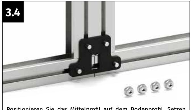
Positionieren Sie das Mittelprofil auf dem Bodenprofil. Setzen Sie den Doppelverbinder so auf, dass jeweils eine Schraube M6x12 mm durch die Löcher des Doppelprofils ragt.
