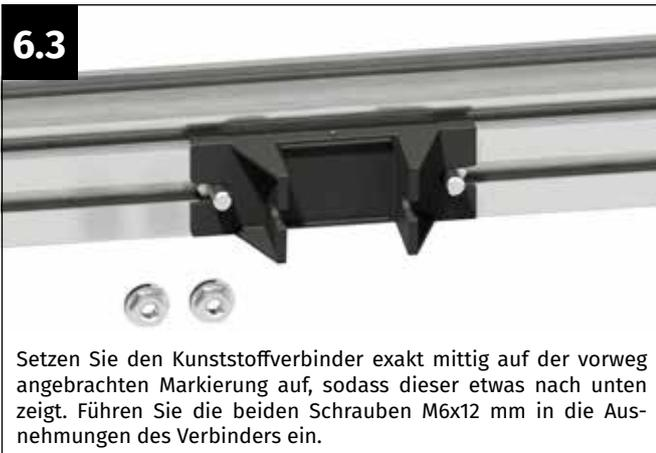
Setzen Sie den Kunststoffverbinder exakt mittig auf der vorweg angebrachten Markierung auf, sodass dieser etwas nach unten zeigt. Führen Sie die beiden Schrauben M6x12 mm in die Ausnehmungen des Verbinders ein.
