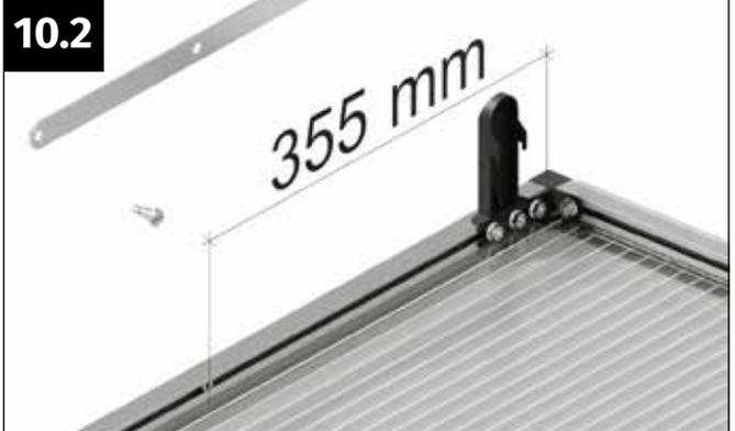
Positionieren Sie die Mutter M6 exakt an der Markierung.
