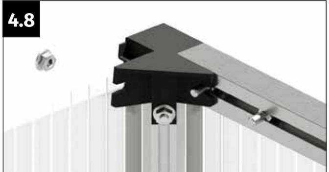
Stecken Sie das vordere Auflageprofil auf den Eckwinkel auf und positionieren Sie eine Schraube M6x12 mm in dessen Ausnehmung.
