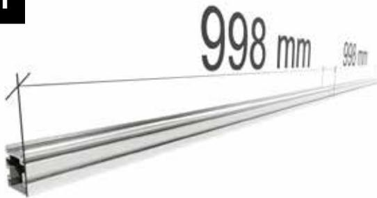
Nehmen Sie das Firstprofil (Länge 1996 mm) zur Hand. Messen Sie von der Schnittkante des Profils 998 mm nach innen und setzen Sie hier eine Markierung.
