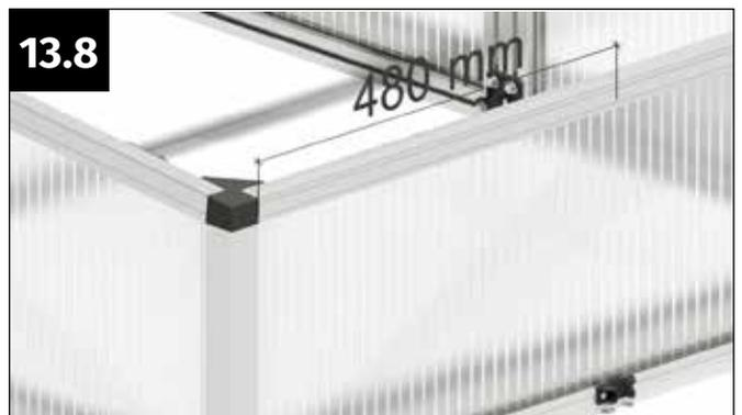
Markieren Sie die Position der Aufstellerfixierung, indem Sie von jeder Seite des oberen Auflageprofils 480 mm nach innen messen.
