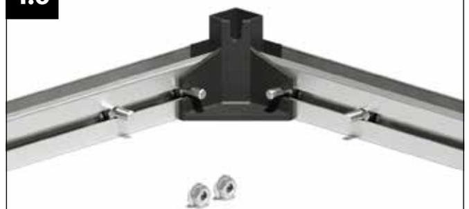
Führen Sie jeweils eine Schraube M6x12 mm in die vorgesehenen Ausnehmungen des unteren Eckwinkels ein.
