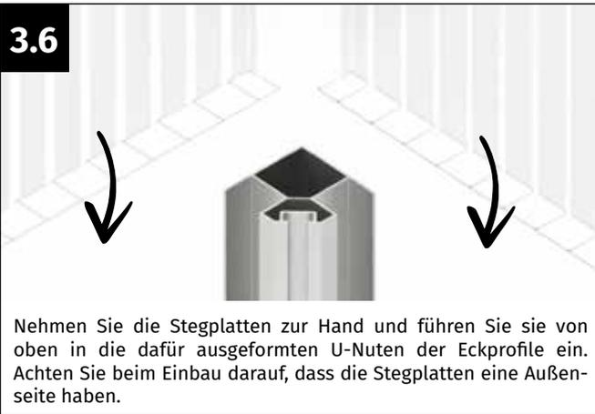
Nehmen Sie die Stegplatten zur Hand und führen Sie sie von oben in die dafür ausgeformten U-Nuten der Eckprofile ein. Achten Sie beim Einbau darauf, dass die Stegplatten eine Außen-seite haben.
