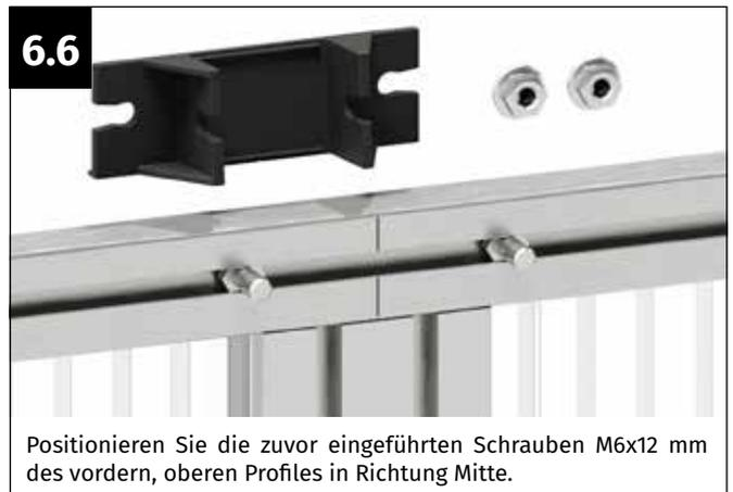
Positionieren Sie die zuvor eingeführten Schrauben M6x12 mm des vordern, oberen Profiles in Richtung Mitte.
