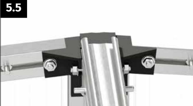
Drücken Sie das Firstprofil fest gegen den Verbinder und verschrauben Sie den First fest mit den Flanschmuttern M6
