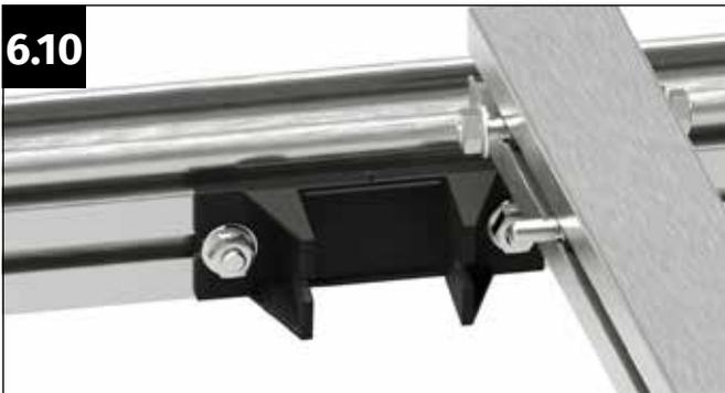
Führen Sie jeweils zwei Schrauben M6x12 mm in jeden der beiden Schraubkanäle des Auflageprofils ein. Drehen Sie dann eine Flanschnutter M6 auf jede der vorderen Schrauben M6x12 mm.
