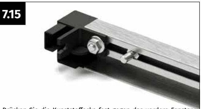
Drücken Sie die Kunststoffecke fest gegen das vordere Fensterprofil und verschrauben Sie diese fest mit der Flanschmutter M6. Wiederholen Sie diese Montageschritte auf der zweiten Seite des vorderen Fensterprofils.
