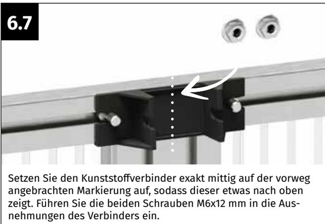
Setzen Sie den Kunststoffverbinder exakt mittig auf der vorweg angebrachten Markierung auf, sodass dieser etwas nach oben zeigt. Führen Sie die beiden Schrauben M6x12 mm in die Ausnehmungen des Verbinders ein.
