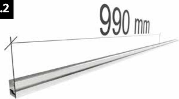
Nehmen Sie die beiden Bodenprofile der Front- und Rückwand zur Hand. Messen Sie von der Schnittkante des Profils 990 mm nach innen und setzen Sie hier jeweils eine Markierung.
