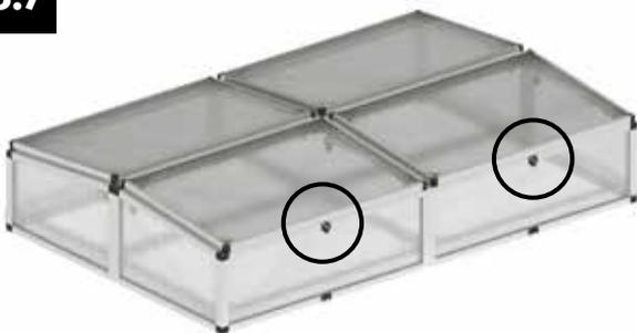
Als nächstes werden die Aufstellerfixierungen am oberen Rahmenprofil montiert..
