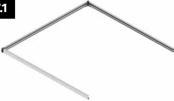
Im ersten Schritt werden das hintere Scharnierprofil und zwei Fenster-Seitenprofile mit den Kunststoffecken des Fensters (Teil Nr. G2307) verschraubt.
