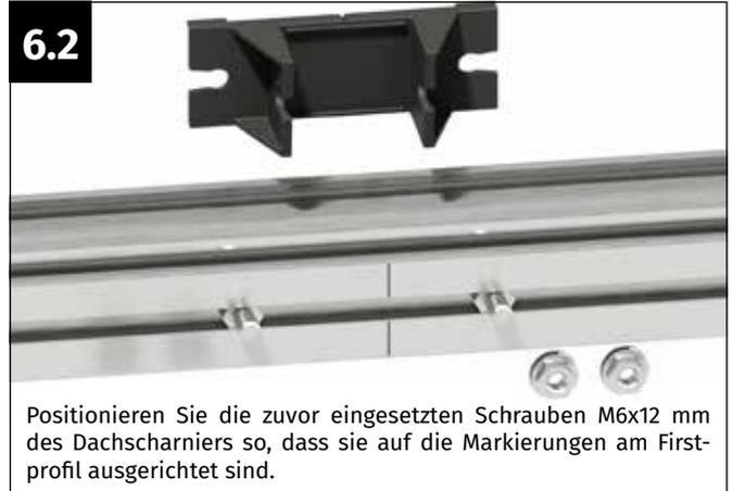
Positionieren Sie die zuvor eingesetzten Schrauben M6x12 mm des Dachscharniers so, dass sie auf die Markierungen am Firstprofil ausgerichtet sind.
