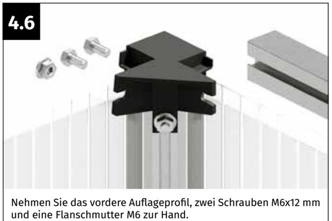
Nehmen Sie das vordere Auflageprofil, zwei Schrauben M6x12 mm und eine Flanschmutter M6 zur Hand.
