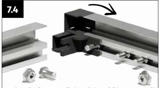
Stecken Sie die Kunststoffecke auf das seitliche Fensterprofil auf. Führen Sie eine Schraube M6x12 mm in die Ausnehmung der Kunststoffecke ein.
