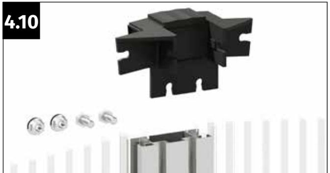
Setzen Sie den Verbinder des Firstprofils auf das Koppelprofil auf. Nehmen Sie dafür den Verbinder, zwei Schrauben M6x12 mm und zwei Flanschmutter M6 zur Hand.
