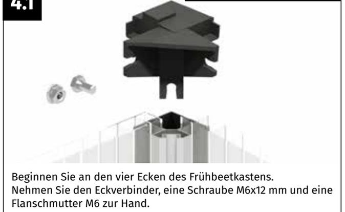
Beginnen Sie an den vier Ecken des Frühbeetkastens. Nehmen Sie den Eckverbinder, eine Schraube M6x12 mm und eine Flanschmutter M6 zur Hand.
