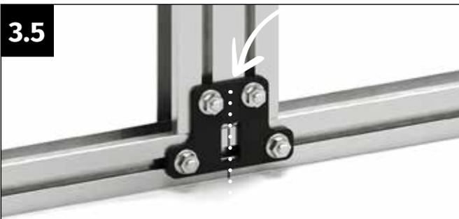
Richten Sie das Doppelprofil so aus, dass die V-Markierung in der Mitte des Doppelprofils exakt auf die angebrachte Markierung zeigt. Verschrauben Sie den Doppelverbinder fest mit vier Flanschmuttern M6.
