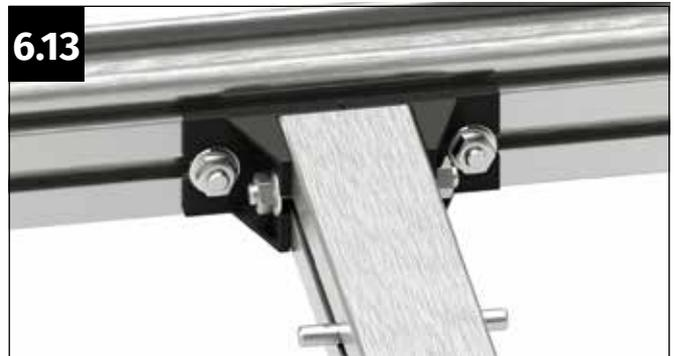
Führen Sie die Schrauben M6x12 mm in die Ausnehmung des Kunststoffverbinders ein und verschrauben Sie das Profil an beiden Seiten fest mit den Flanschnuttern M6.
