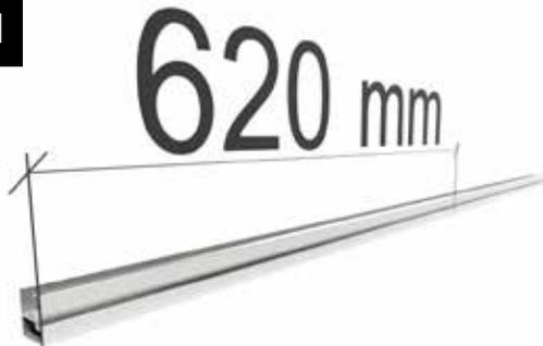
Nehmen Sie die beiden Bodenprofile der Seitenwand zur Hand. Messen Sie von der Schnittkante des Profils 620 mm nach innen und setzen Sie hier jeweils eine Markierung.
