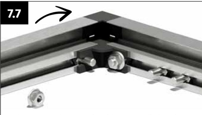
Stecken Sie das Scharnierprofil auf die Kunststoffecke auf. Führen Sie die Schraube M6x12 mm in die Ausnehmung der Kunststoffecke ein.
