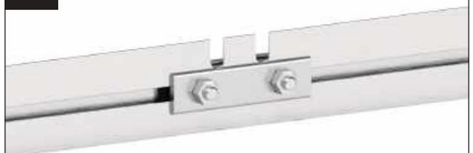
Drücken Sie die Bodenprofile fest aneinander, sodass kein Spalt mehr gegeben ist. Verschrauben Sie die Profile fest mit den zwei Muttern M6.
