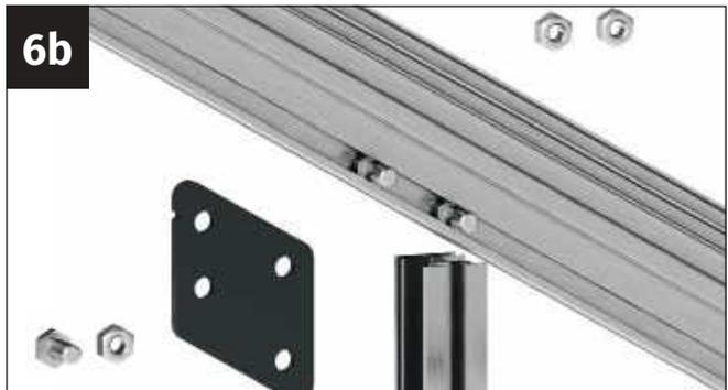
Schrauben Sie die Muttern M6 von den beiden Schrauben ab. Nehmen Sie ein Knotenblech der Querstrebe sowie eine Schraube M6x12 mm und eine Mutter M6 zur Hand.
