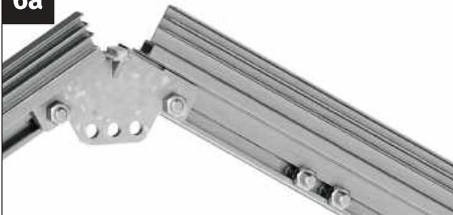
Lockern Sie die beiden Muttern M6 der vorweg im Firstbereich eingeführten Schrauben M6x12 mm und führen Sie die Schrauben in Richtung des oberen Endes des Türeingangsprofils.
