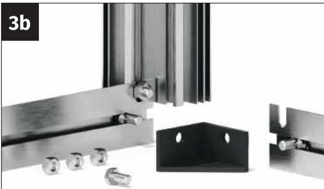
Führen Sie jeweils eine Schraube M6x12 mm in den Schraubkanal des Bodenprofils der Front- und der Seitenwand ein.
