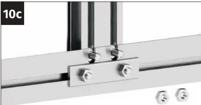
Positionieren Sie die Koppelstrebe der Rückwand auf dem Bodenprofil und führen Sie die beiden Schrauben M6x12 mm in die Aussparungen des Bodenprofils ein.
