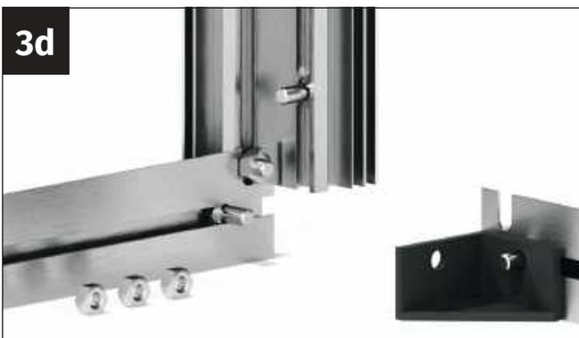
Setzen Sie die Kunststoffecke des Bodenprofils auf die Schraube M6x12 mm des seitlichen Bodenprofils.
