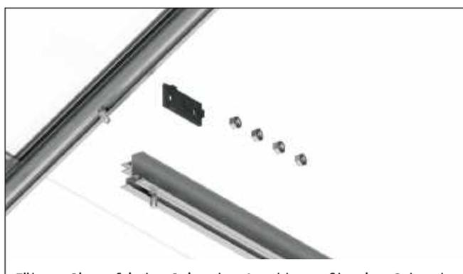
Führen Sie auf jeder Seite des Anschlagprofils eine Schraube M6x12 mm in den Schraubkanal ein. Setzen Sie je eine Rhombusschraube in den Schraubkanal der Dachstrebe ein.
