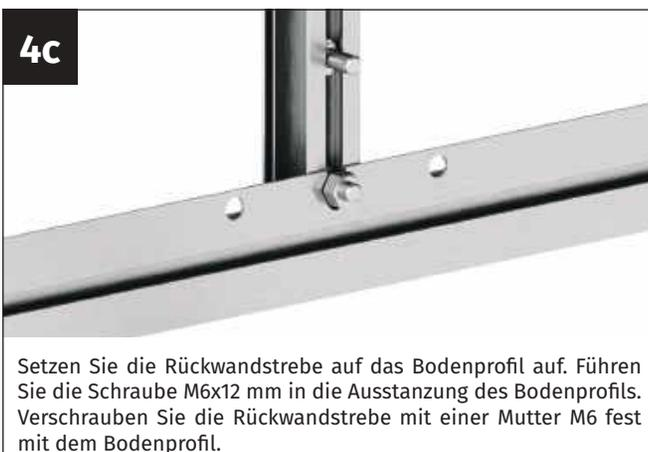
Setzen Sie die Rückwandstrebe auf das Bodenprofil auf. Führen Sie die Schraube M6x12 mm in die Ausstanzung des Bodenprofils. Verschrauben Sie die Rückwandstrebe mit einer Mutter M6 fest mit dem Bodenprofil.
