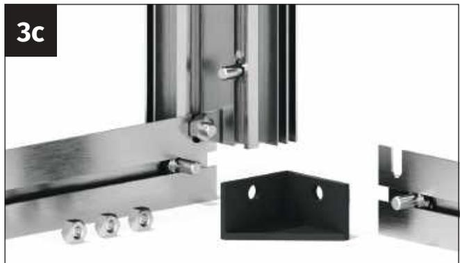
Führen Sie eine Schraube M6x12 mm in den Schraubkanal des Seiteneckprofils ein.
