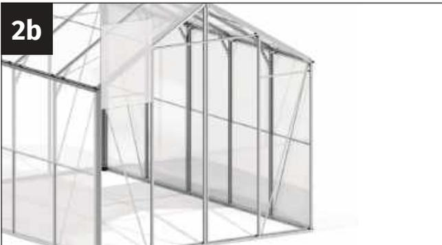
Nehmen Sie die untere Glasplatte der Rückwand (525 × 713 mm) zur Hand und führen Sie diese von oben in das äußere Feld des Gewächshauses ein.
