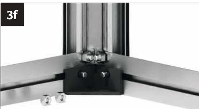
Führen Sie die Schraube M6x12 mm des Seiteneckprofils in die Ausstanzung des Bodenprofils und verschrauben Sie diese fest mit einer Mutter M6.
