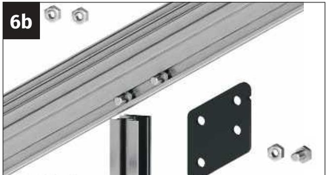
Nehmen Sie die Muttern M6 von den beiden Schrauben ab. Nehmen Sie ein Knotenblech der Querstrebe sowie eine Schraube M6x12 mm und eine Mutter M6 zur Hand.
