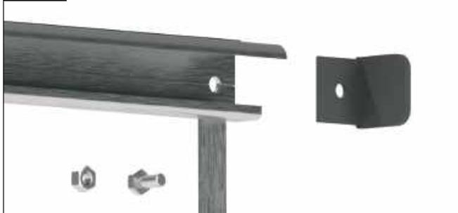
Nehmen Sie einen Türschienenschutz, eine Schraube M6x12 und eine Mutter M6 zur Hand.
