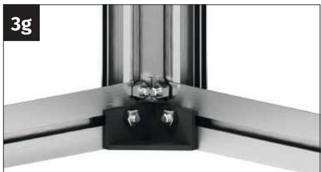
Richten Sie den Bodenknoten so aus, dass er exakt in der Ecke der Bodenprofile positioniert ist. Verschrauben Sie den Bodenknoten mit zwei Muttern M6 fest mit den Bodenprofilen.
