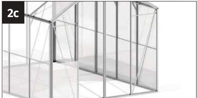
Führen Sie die Platte behutsam nach unten, bis sie am Bodenprofil aufliegt. Es kann dafür notwendig sein, den Windverband an der Innenseite nochmals zu lockern, um das Gewächshaus exakt im Lot ausrichten zu können.
