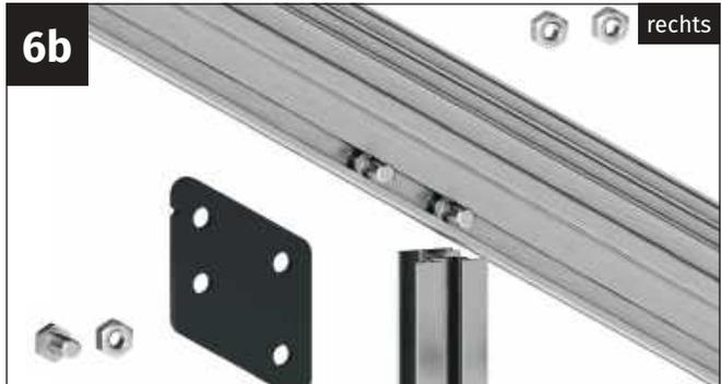
Schrauben Sie die Muttern M6 von den beiden Schrauben ab. Nehmen Sie ein Knotenblech der Querstrebe sowie eine Schraube M6x12 mm und eine Mutter M6 zur Hand.
