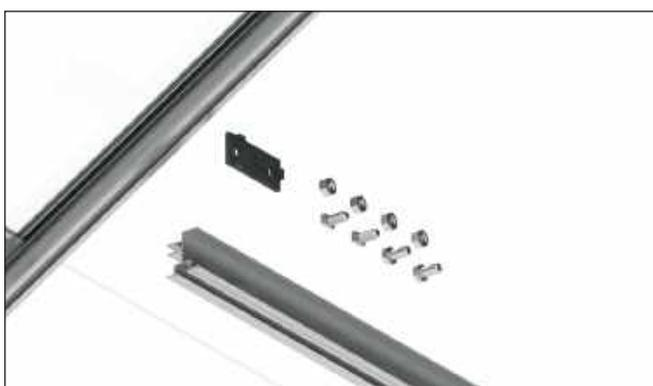
Nehmen Sie zwei Verbinderknoten gerade, zwei Schrauben M6x12, zwei Rhombusschrauben sowie vier Muttern zur Hand.
