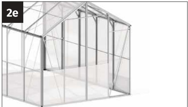
Führen Sie die Platten behutsam nach unten, bis sie am Bodenprofil aufliegen.
