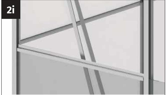
Setzen Sie jeweils ein H-Profil auf die unteren Glasplatten der Rückwand auf.
