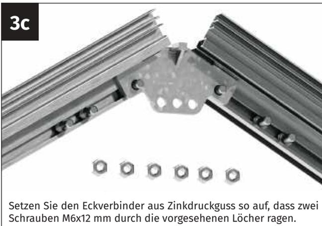
Setzen Sie den Eckverbinder aus Zinkdruckguss so auf, dass zwei Schrauben M6x12 mm durch die vorgesehenen Löcher ragen.
