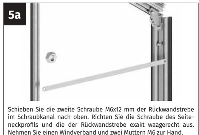
Schieben Sie die zweite Schraube M6x12 mm der Rückwandstrebe im Schraubkanal nach oben. Richten Sie die Schraube des Seitennecksprofils und die der Rückwandstrebe exakt waagrecht aus. Nehmen Sie einen Windverband und zwei Muttern M6 zur Hand.
