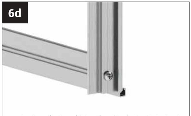
Verschrauben Sie das seitliche Türprofil mit der Blechschraube 4,2 x 22 mm fest mit dem unteren Bodenprofil.
