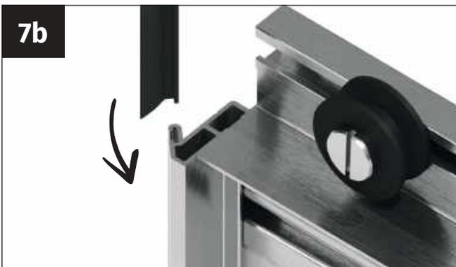
Längen Sie die Türdichtung auf die Länge des seitlichen Türprofils ab und führen Sie diese in die dafür vorgesehene Nut ein.
