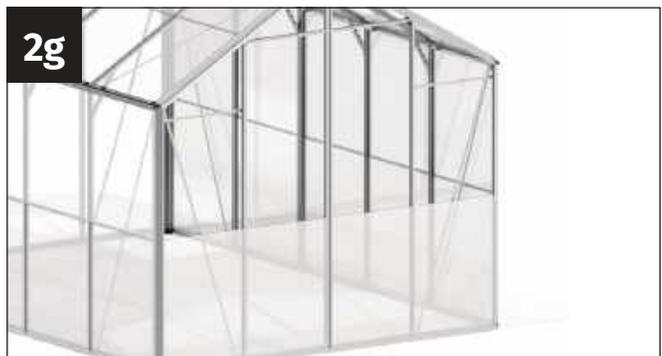
Führen Sie die Platte behutsam nach unten, bis sie am Bodenprofil aufliegt.
