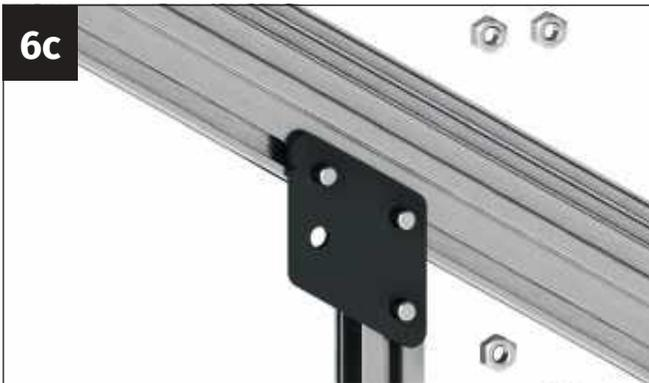
Setzen Sie das Knotenblech der Querstrebe so auf, dass die drei Schrauben durch die Löcher des Knotenbleches ragen.
