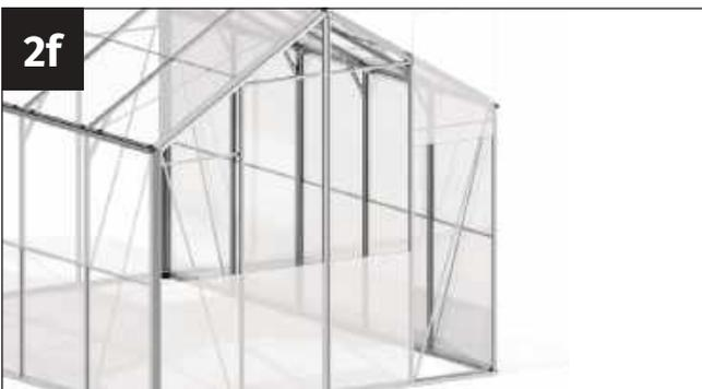
Nehmen Sie eine weitere untere Glasplatte der Rückwand (525 × 713 mm) zur Hand und führen Sie diese von oben in das äußere Feld des Gewächshauses ein.
