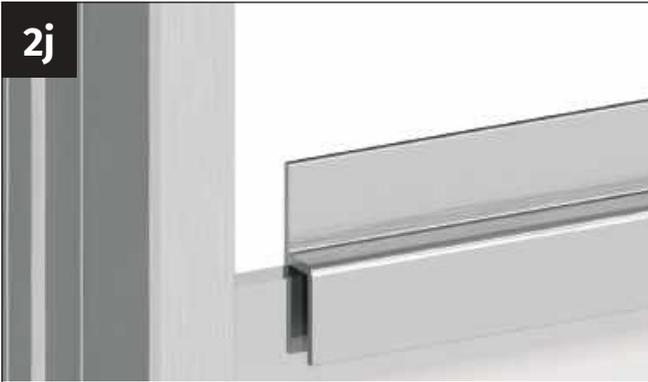
Setzen Sie das H-Profil so auf, dass der hintere Schenkel an der Innenseite der Verglasung nach oben zeigt.
