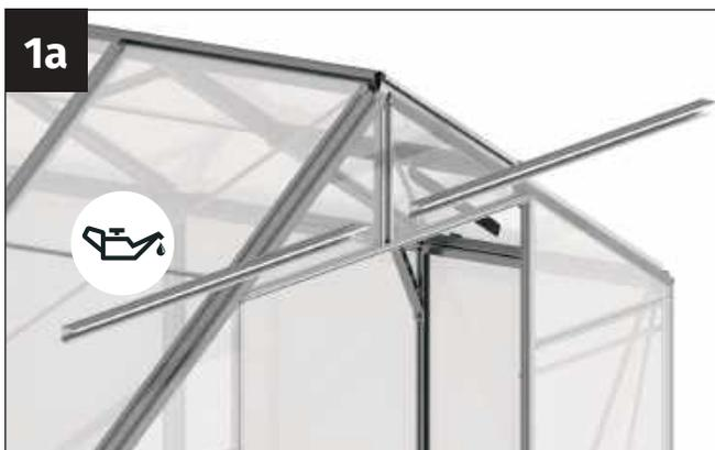
1a Nehmen Sie die beiden Türlaufschienen zur Hand.
