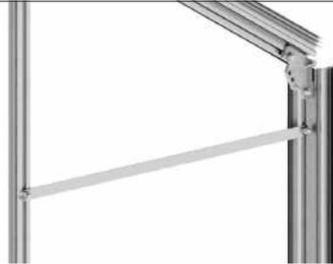
Richten Sie den Windverband so aus, dass dieser exakt waagrecht ist und verschrauben Sie diesen mit zwei Muttern M6.
