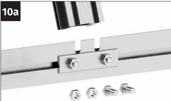
Nehmen Sie die Koppelstrebe der Rückwand sowie zwei Schrauben M6x12 mm und zwei Muttern M6 zur Hand.
