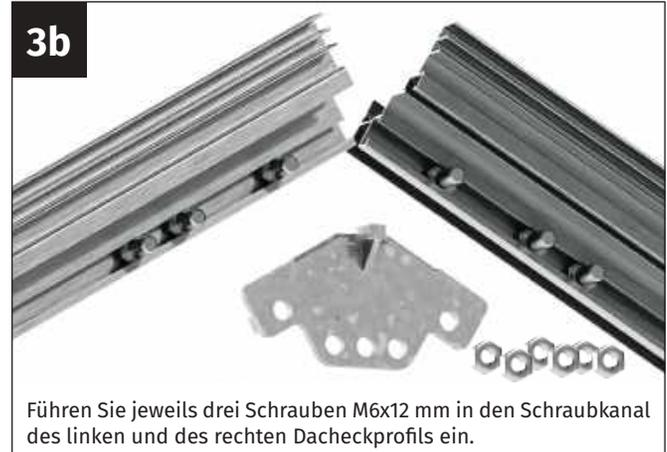
Führen Sie jeweils drei Schrauben M6x12 mm in den Schraubkanal des linken und des rechten Dacheckprofils ein.
