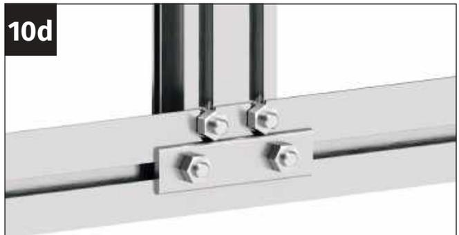
Verschrauben Sie das Koppelprofil der Rückwand mit zwei Muttern M6 fest mit dem Bodenprofil.
