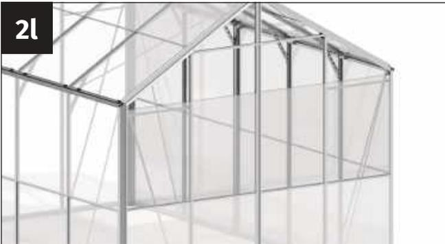
Führen Sie nun in jedes der vier Felder eine Glasplatte 525 x 680 mm ein. Diese werden so positioniert, dass sie bündig an den H-Profilen aufliegen.
