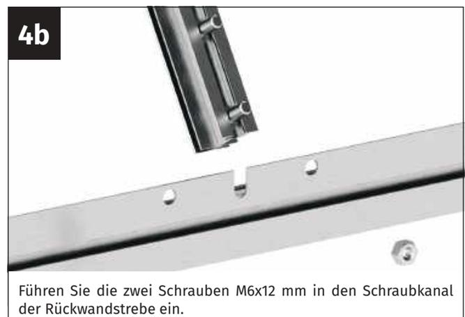
Führen Sie die zwei Schrauben M6x12 mm in den Schraubkanal der Rückwandstrebe ein.
