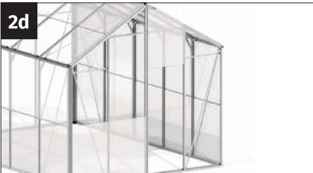
Nehmen Sie eine weitere untere Glasplatte der Rückwand (525 × 713 mm) zur Hand und führen Sie diese von oben in das mittlere Feld des Gewächshauses ein.
