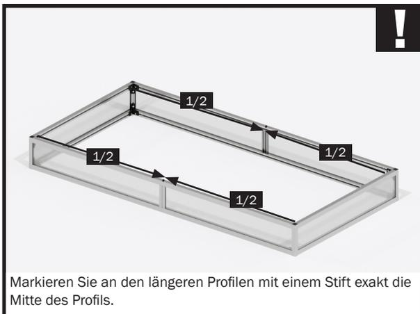
Markieren Sie an den längeren Profilen mit einem Stift exakt die Mitte des Profils.
