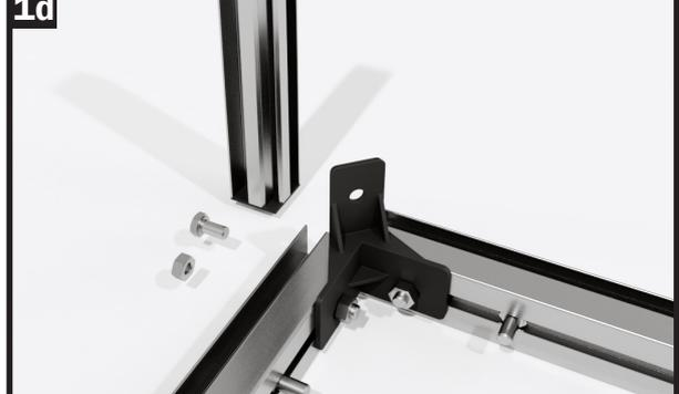
Nehmen Sie das Eckprofil sowie eine Schraube M6x12 mm und eine Mutter M6 zur Hand.
