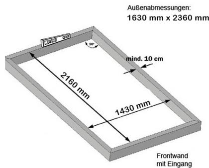
Bemaßung: Aussenkanten Punktfundament
