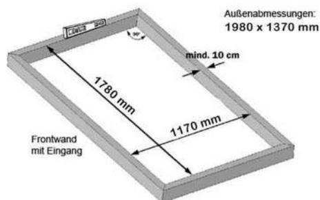
Bemaßung: Aussenkanten Punktfundament
