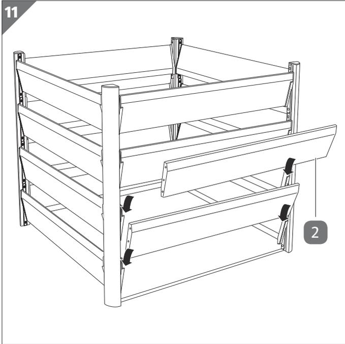
1. Schieben Sie eine der verbliebenen Aluminiumplanken (2) in zwei gegenüber liegende Steckprofile (4/5), die Sie bereits an den vorderen Eckpfosten (1) montiert haben.
