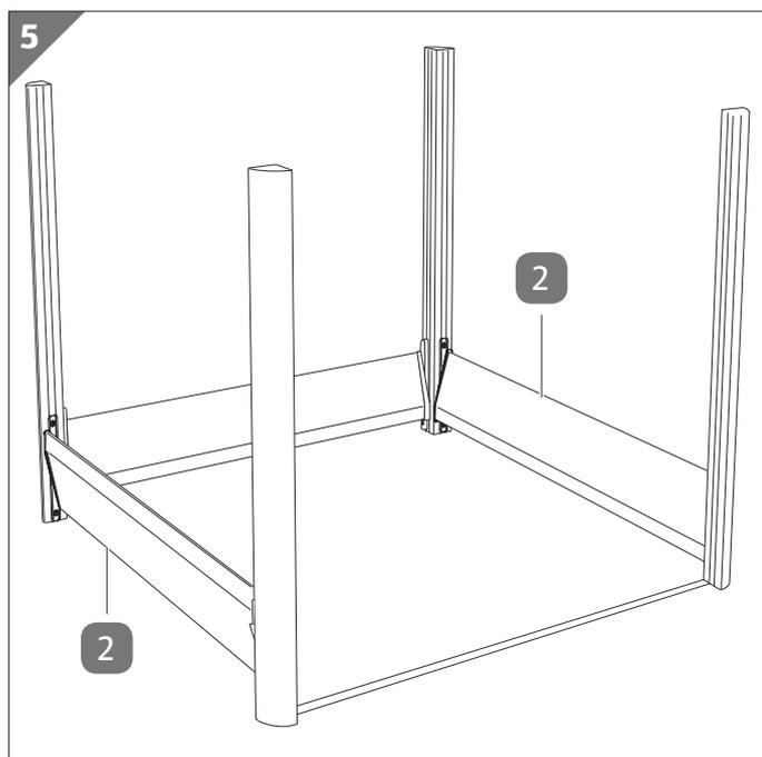
1. Richten Sie mithilfe einer zweiten Person die teilweise montierte Frontseite und die teilweise montierte Rückwand auf. Achten Sie darauf, dass die aufgerichteten Komponenten nicht umkippen.
