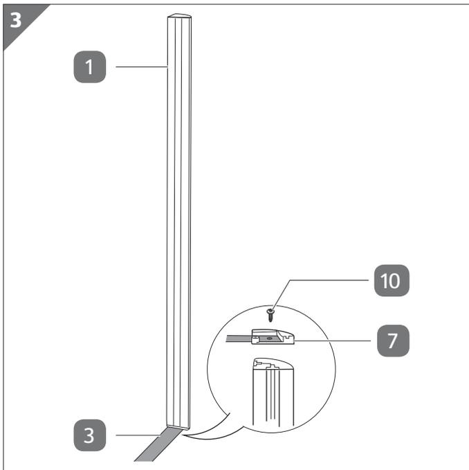
Im dritten Schritt werden die beiden verbleibenden Eckpfosten über die Querstrebe miteinander verbunden.
