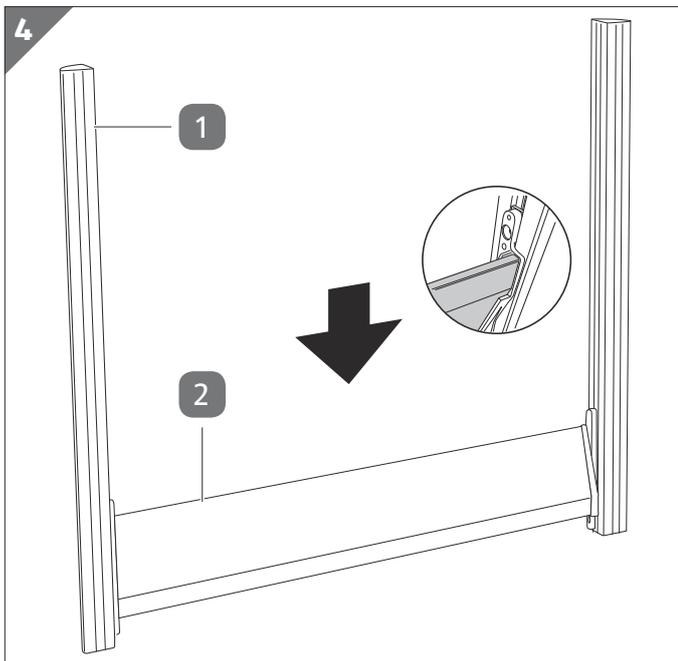
Im vierten Schritt werden die beiden in Schritt 2 vormontierten Eckpfosten über eine Aluminiumplanke miteinander verbunden.
