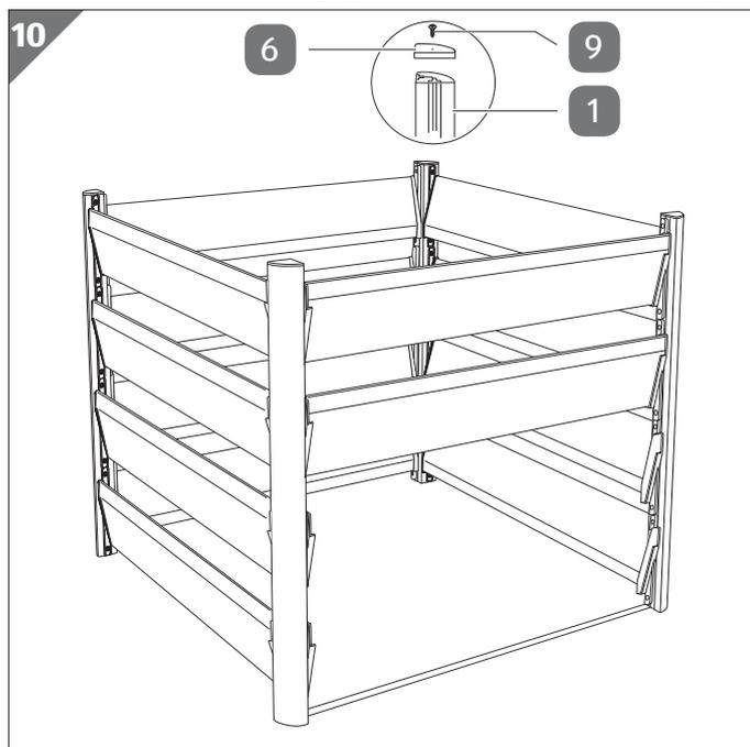
1. Setzen Sie eine Kunststoff-Deckelkappe **6** oben auf einen der Eckpfosten **1**.
