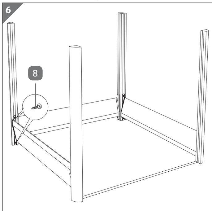
1. Verschrauben Sie eine der drei bereits eingesetzten Aluminiumplanken (2) wie dargestellt mit den Eckpfosten (1). Verwenden Sie dazu auf jeder Seite zwei Senkkopfschrauben  $4,2 \times 16$  mm (8).
