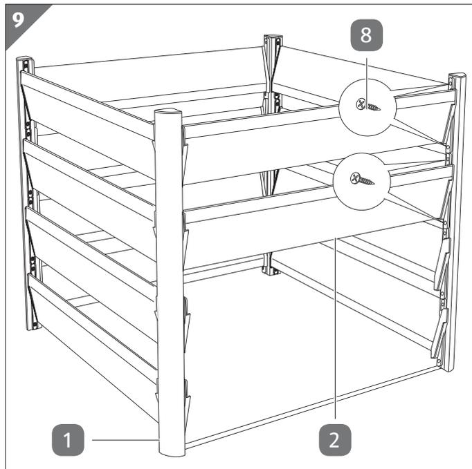
1. Nehmen Sie eine der beiden verbliebenen mit Steckprofilen **4**/**5** versehenen Aluminiumplanken **2**.
