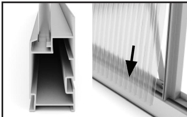
Drücken Sie die Unterseite an die Seitenwandstrebe und anschließend in die Nut des Bodenprofils.
