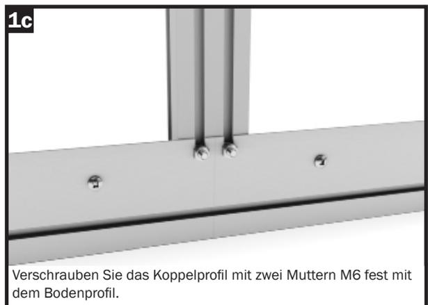
Verschrauben Sie das Koppelprofil mit zwei Muttern M6 fest mit dem Bodenprofil.
