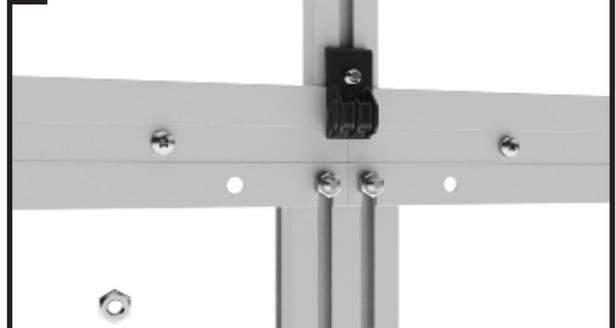
Platzieren Sie die Befestigungsklemme und positionieren Sie die Dachstütze mit der Klemme genau mittig auf der Querstrebe.
