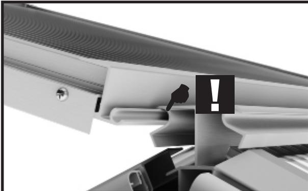
Achten Sie darauf, dass der Scharnierkegel des Fensterflügels im den Scharnierteil des Firstprofils eingeführt ist.
