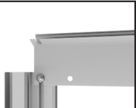
Setzen Sie die Regenrinne auf und verschrauben Sie diese mit einer Mutter M6 fest mit dem Seiteneckprofil.
