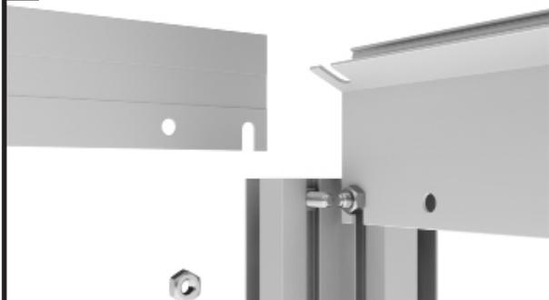
Führen Sie die Schraube M6x12 in den Schraubenkanal des Seiteneckprofils ein und setzen Sie die Querstrebe auf.
