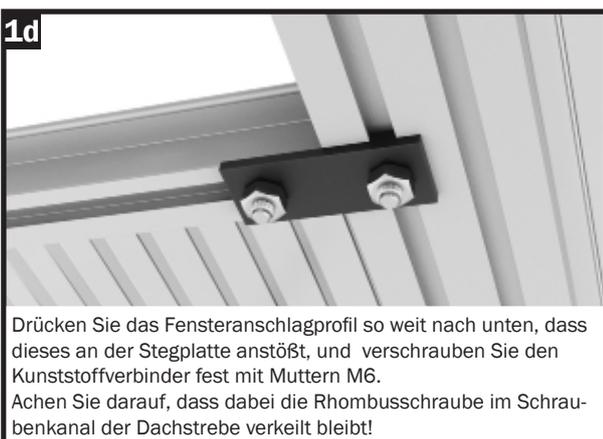
Drücken Sie das Fensteranschlagprofil so weit nach unten, dass dieses an der Stegplatte anstößt, und verschrauben Sie den Kunststoffverbinder fest mit Muttern M6. Achten Sie darauf, dass dabei die Rhobusschraube im Schraubkanal der Dachstrebe verkeilt bleibt!
