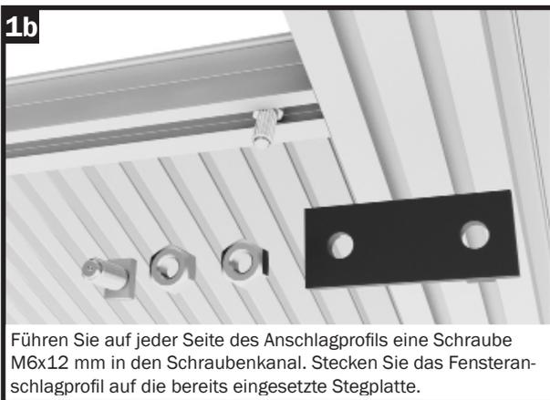
Führen Sie auf jeder Seite des Anschlagprofils eine Schraube M6x12 mm in den Schraubkanal. Stecken Sie das Fensteranschlagprofil auf die bereits eingesetzte Stegplatte.
