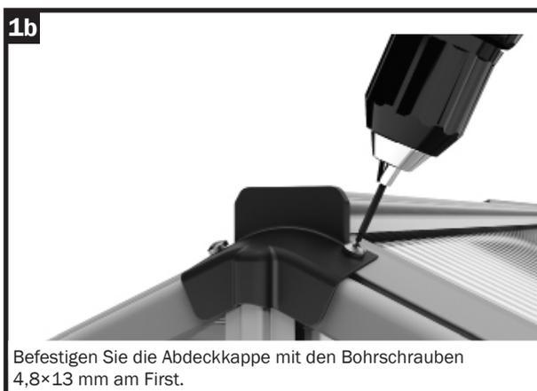
Befestigen Sie die Abdeckkappe mit den Bohrschrauben 4,8x13 mm am First.
