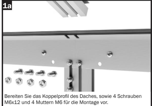
Bereiten Sie das Koppelprofil des Daches, sowie 4 Schrauben M6x12 und 4 Muttern M6 für die Montage vor.
