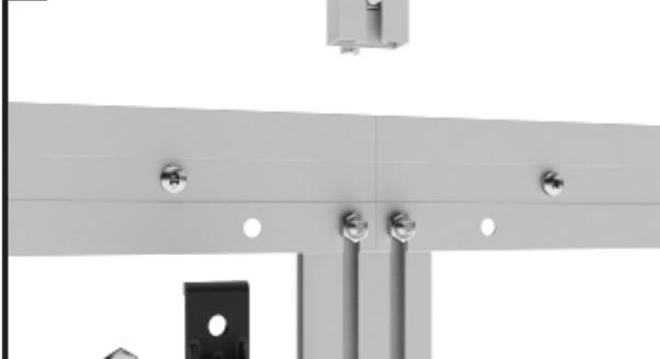
Führen Sie eine Schraube M6x12 in den Schraubkanal der Dachstütze.
