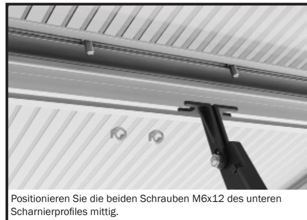
Positionieren Sie die beiden Schrauben M6x12 des unteren Scharnierprofils mittig.
