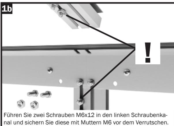
Führen Sie zwei Schrauben M6x12 in den linken Schraubkanal und sichern Sie diese mit Muttern M6 vor dem Verrutschen.
