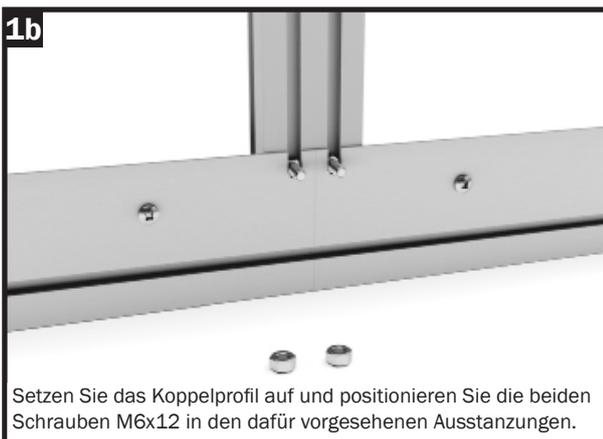
Setzen Sie das Koppelprofil auf und positionieren Sie die beiden Schrauben M6x12 in den dafür vorgesehenen Ausstanzungen.
