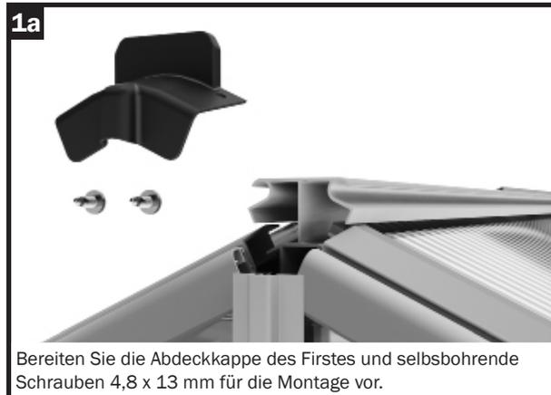
Bereiten Sie die Abdeckkappe des Firstes und selbstbohrende Schrauben 4,8 x 13 mm für die Montage vor.
