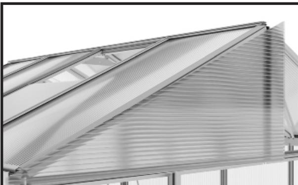
Setzen Sie die Dreiecksplatte so ein, daß diese auf der Querstrebe aufliegt und fest an der Giebelstütze anstoßt.
