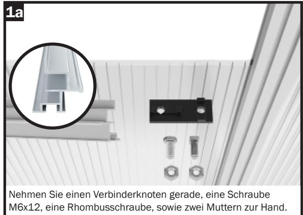
Nehmen Sie einen Verbinderknoten gerade, eine Schraube M6x12, eine Rhobusschraube, sowie zwei Muttern zur Hand.
