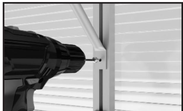
Nehmen Sie die selbstbohrenden Schrauben 4,8x13 mm zur Hand und positionieren Sie die Versteifung
