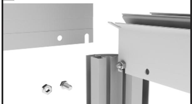
Bereiten Sie die Querstrebe, sowie eine Schraube M6x12 und eine Mutter M6 vor.
