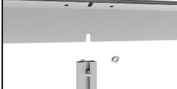
Führen Sie eine Schraube M6x12 in den Schraubkanal der Strebe.
