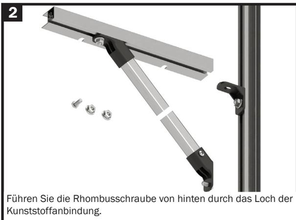
Führen Sie die Rhombusschraube von hinten durch das Loch der Kunststoffanbindung.
