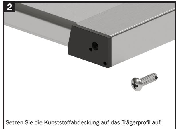
Setzen Sie die Kunststoffabdeckung auf das Trägerprofil auf.
