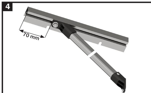
Richten Sie die Stütze nochmals exakt aus. Der Abstand zwischen Strebenende und Kunststoffanbindung besträgt 70 mm. Verschrauben Sie die Stütze mit einer Flanschnutter M6.
