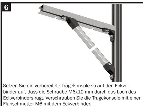
Setzen Sie die vorbereitete Tragekonsole so auf den Eckverbinder auf, dass die Schraube M6x12 mm durch das Loch des Eckverbinders ragt. Verschrauben Sie die Tragekonsole mit einer Flanschmutter M6 mit dem Eckverbinder.
