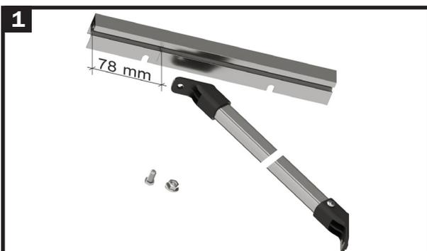
Nehmen Sie eine Regalstrebe eine Stütze, eine Schraube M6x12 mm und eine Flanschnutter M6 zur Hand.
