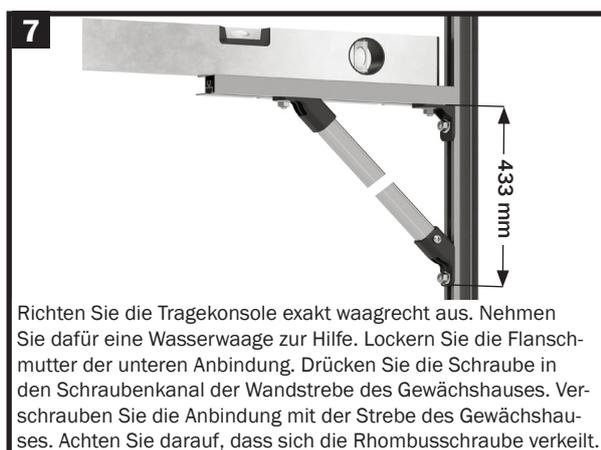
Richten Sie die Tragekonsole exakt waagrecht aus. Nehmen Sie dafür eine Wasserwaage zur Hilfe. Lockern Sie die Flanschmutter der unteren Anbindung. Drücken Sie die Schraube in den Schraubenkanal der Wandstrebe des Gewächshauses. Verschrauben Sie die Anbindung mit der Strebe des Gewächshauses. Achten Sie darauf, dass sich die Rhombusschraube verkeilt.
