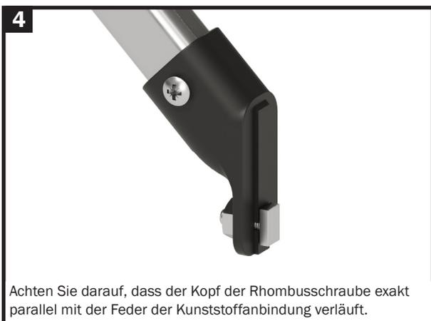
Achten Sie darauf, dass der Kopf der Rhombusschraube exakt parallel mit der Feder der Kunststoffanbindung verläuft.
