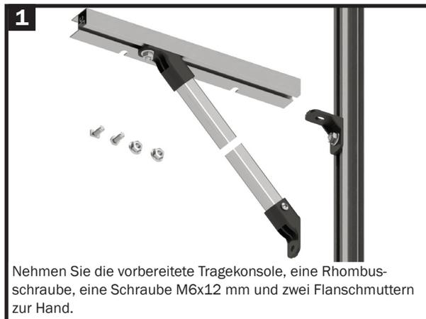
Nehmen Sie die vorbereitete Tragekonsole, eine Rhombusschraube, eine Schraube M6x12 mm und zwei Flanschmutter zur Hand.
