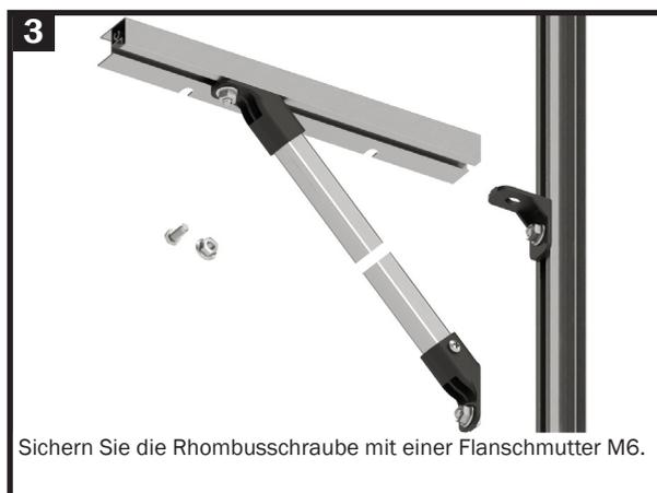
Sichern Sie die Rhombusschraube mit einer Flanschmutter M6.
