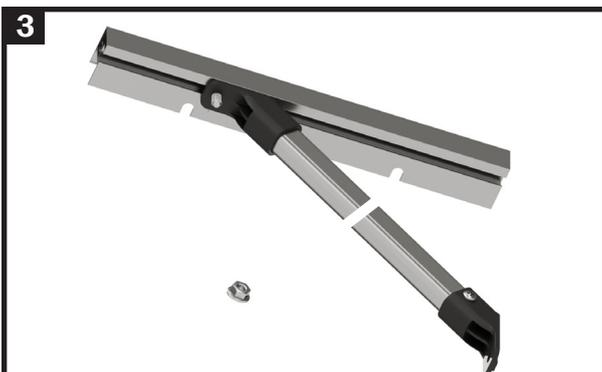
Setzen Sie die Stütze so auf, dass die Schraube M6x12 mm durch das Loch der Kunststoffanbindung ragt.
