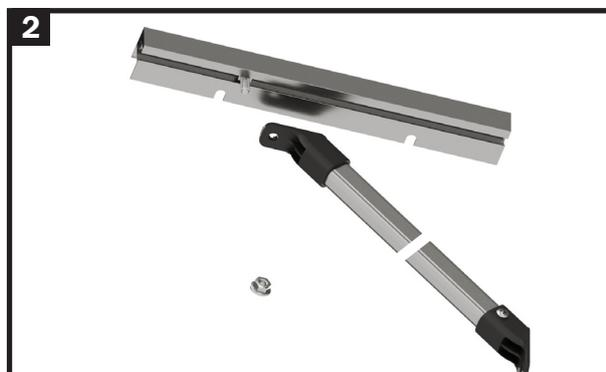
Führen Sie die Schraube M6x12 mm von vorne in den Schraubenkanal der Regalstrebe ein. Positionieren Sie die Schraube exakt an der Markierung (78 mm).
