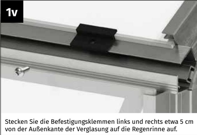
1v Stecken Sie die Befestigungsklemmen links und rechts etwa 5 cm von der Außenkante der Verglasung auf die Regenrinne auf.
