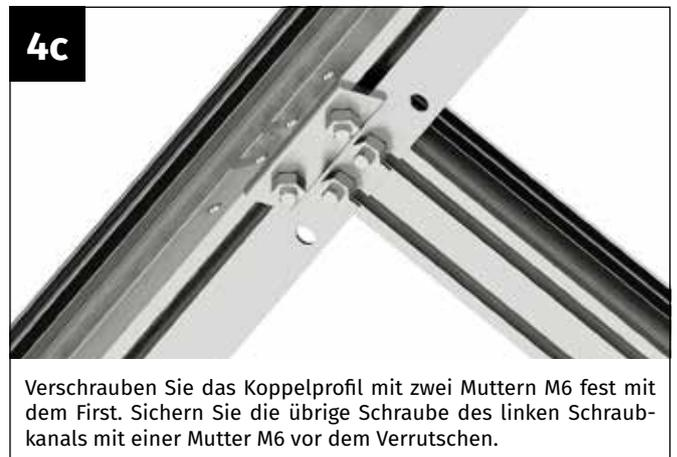
Verschrauben Sie das Koppelprofil mit zwei Muttern M6 fest mit dem First. Sichern Sie die übrige Schraube des linken Schraubkanals mit einer Mutter M6 vor dem Verrutschen.
