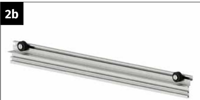
Führen Sie die Mutter in den Schraubkanal des Türrollenprofils ein. Stecken Sie den Achsbolzen in die Türrolle. Verschrauben Sie den Achsbolzen mit der Mutter. Wir empfehlen die Türrolle jeweils etwa 30 mm vom Ende des Türrollenprofils zu positionieren.
