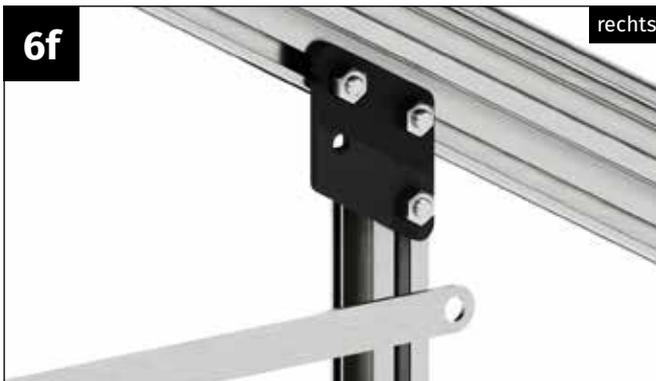
Positionieren Sie die Querstrebe hinter dem Kunststoff-Verbinderknoten der Querstrebe.
