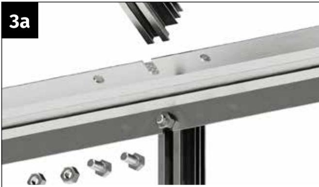
Nehmen Sie eine Dachstrebe sowie zwei Schrauben M6x12 mm und zwei Muttern M6 zur Hand.
