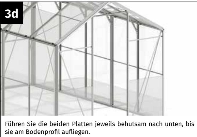
Führen Sie die beiden Platten jeweils behutsam nach unten, bis sie am Bodenprofil aufliegen.
