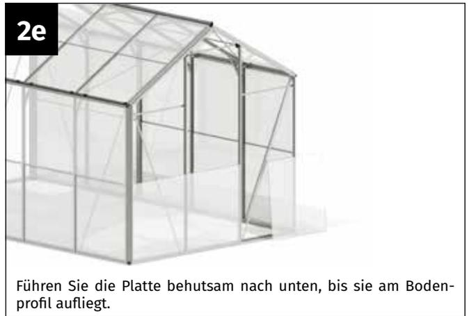
Führen Sie die Platte behutsam nach unten, bis sie am Bodenprofil aufliegt.
