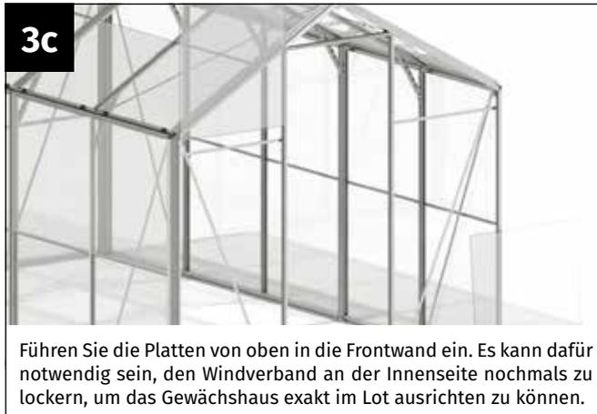
Führen Sie die Platten von oben in die Frontwand ein. Es kann dafür notwendig sein, den Windverband an der Innenseite nochmals zu lockern, um das Gewächshaus exakt im Lot ausrichten zu können.
