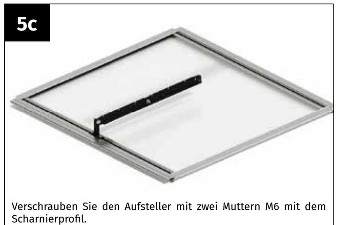
Verschrauben Sie den Aufsteller mit zwei Muttern M6 mit dem Scharnierprofil.
