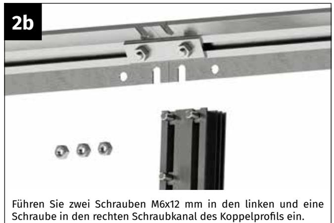
Führen Sie zwei Schrauben M6x12 mm in den linken und eine Schraube in den rechten Schraubkanal des Koppelprofils ein.
