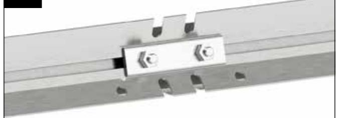
Drücken Sie die Regenrinnenteile fest aneinander, sodass kein Spalt mehr gegeben ist. Verschrauben Sie die Profile fest mit den zwei Muttern M6.
