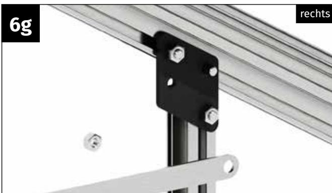
Entfernen Sie an beiden die Mutter von der mittleren Verschraubung der Querstrebe.
