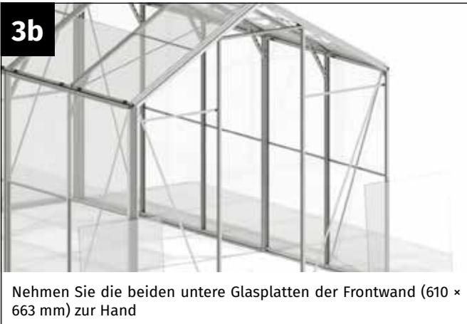
Nehmen Sie die beiden untere Glasplatten der Frontwand (610 × 663 mm) zur Hand
