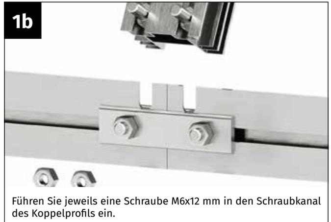
Führen Sie jeweils eine Schraube M6x12 mm in den Schraubkanal des Koppelprofils ein.
