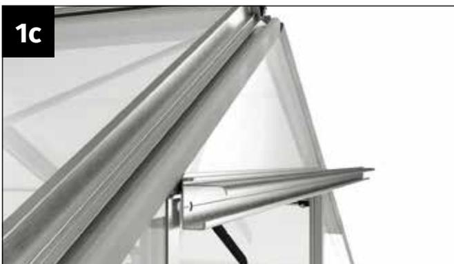
Führen Sie die Türlaufschiene bis zur Mitte der Türöffnung in das Querprofil ein.
