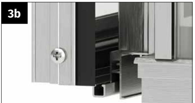
Achten Sie auch darauf, dass der Türflügel an der Unterseite in der am Bodenprofil vorgesehenen Lasche eingehängt wird. Damit wird verhindert, dass der Türflügel unten vom Gewächshaus wegkippen kann.
