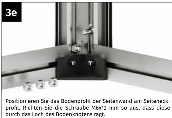
Positionieren Sie das Bodenprofil der Seitenwand am Seiteneckprofil. Richten Sie die Schraube M6x12 mm so aus, dass diese durch das Loch des Bodenknotens ragt.
