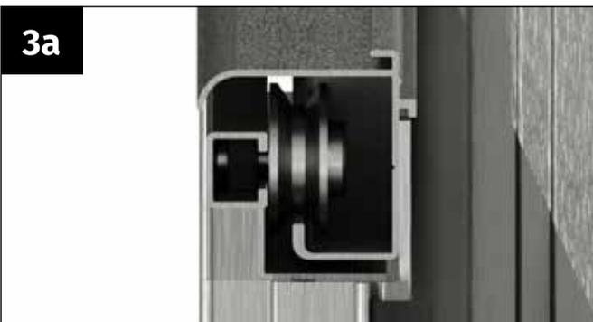
Setzen Sie die Türflügel von rechts in das Gewächshaus ein. Achten Sie darauf, dass die Türrollen oben entsprechend dem gezeigten Querschnitt in der Türlaufschiene eingehängt werden.
