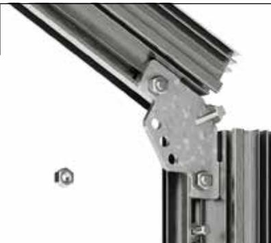
Richten Sie die Profile so aus, dass diese fest am Eckverbinder aus Zinkdruckguss anstoßen. Verschrauben Sie den Eckverbinder mit zwei Muttern M6 fest mit den Profilen.
