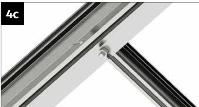
Verschrauben Sie die Strebe mit einer Mutter M6 fest mit dem First. Sichern Sie die zweite Schraube mit einer Mutter vor dem Verrutschen.
