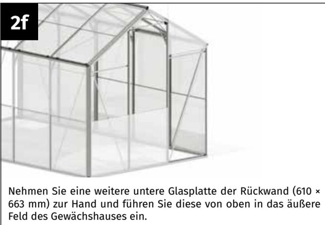
Nehmen Sie eine weitere untere Glasplatte der Rückwand (610 × 663 mm) zur Hand und führen Sie diese von oben in das äußere Feld des Gewächshauses ein.
