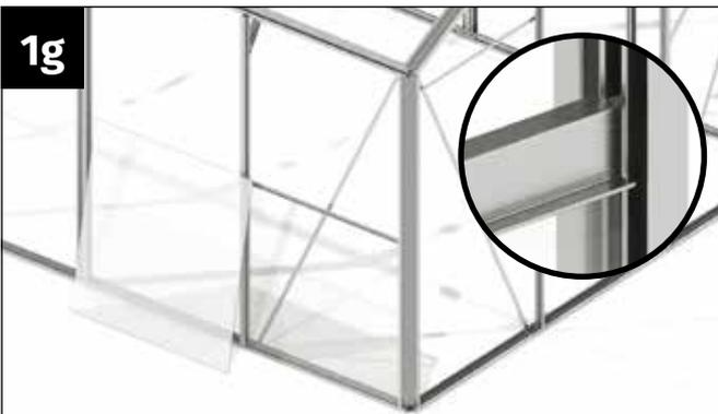
Hängen Sie das S-Profil so in der Glasplatte ein, dass die Auflage-nase nach außen zeigt.
