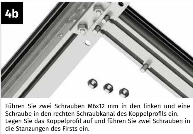
Führen Sie zwei Schrauben M6x12 mm in den linken und eine Schraube in den rechten Schraubkanal des Koppelprofils ein. Legen Sie das Koppelprofil auf und führen Sie zwei Schrauben in die Stanzungen des Firsts ein.
