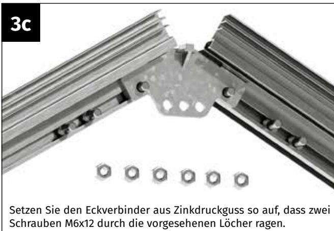
Setzen Sie den Eckverbinder aus Zinkdruckguss so auf, dass zwei Schrauben M6x12 durch die vorgesehenen Löcher ragen.
