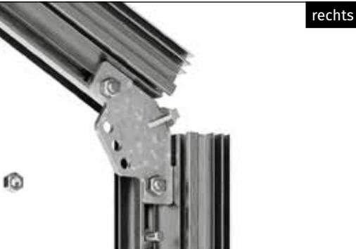
Richten Sie die Profile so aus, dass diese fest am Eckverbinder aus Zinkdruckguss anstoßen. Verschrauben Sie den Eckverbinder mit zwei Muttern M6 fest mit den Profilen.
