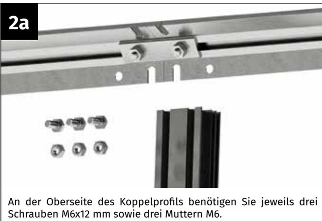
An der Oberseite des Koppelprofils benötigen Sie jeweils drei Schrauben M6x12 mm sowie drei Muttern M6.
