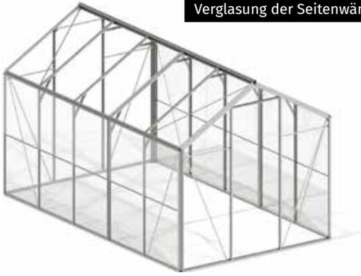
Im ersten Schritt erfolgt die Verglasung der beiden Seitenwände.
