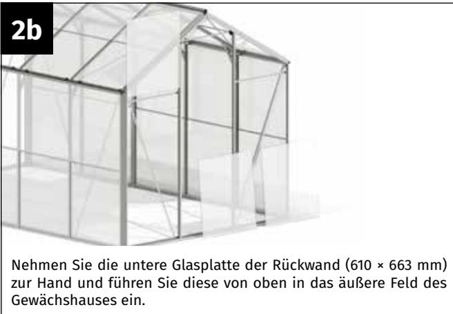
Nehmen Sie die untere Glasplatte der Rückwand (610 × 663 mm) zur Hand und führen Sie diese von oben in das äußere Feld des Gewächshauses ein.
