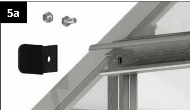
Nehmen Sie einen Türschienschutz, eine Schraube M6x12 mm und eine Mutter M6 zur Hand.
