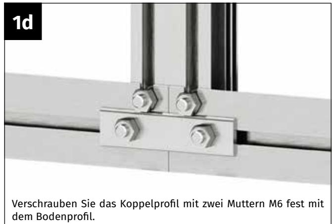
Verschrauben Sie das Koppelprofil mit zwei Muttern M6 fest mit dem Bodenprofil.
