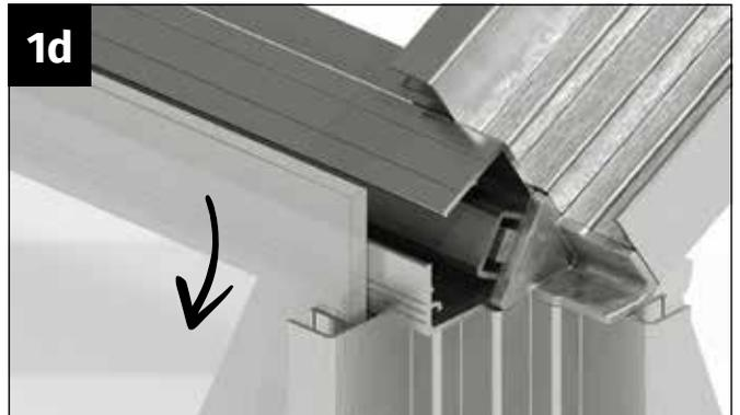
Führen Sie die Glasplatte von oben in die hintere U-Aufnahme des Seiteneckprofils und der Seitenwandstrebe ein.
