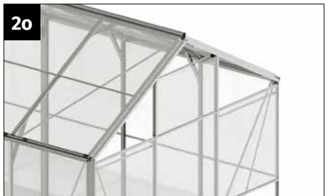
Setzen Sie die Glasplatte ins mittlere Feld ein.
