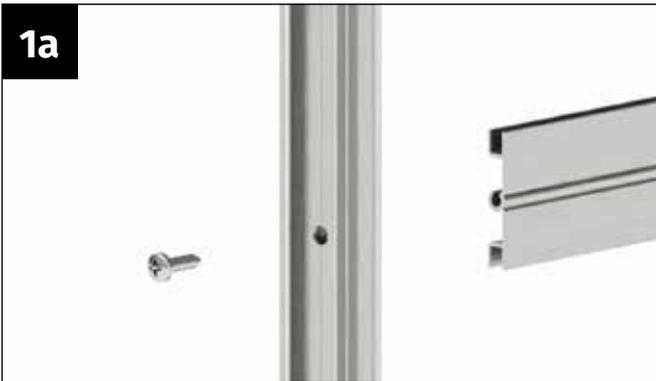
Nehmen Sie das Türprofil seitlich, die Türsprosse sowie eine Blechschraube 4,2 x 22 mm zur Hand.
