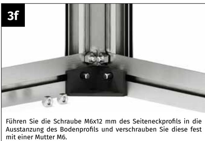
Führen Sie die Schraube M6x12 mm des Seiteneckprofils in die Ausstanzung des Bodenprofils und verschrauben Sie diese fest mit einer Mutter M6.
