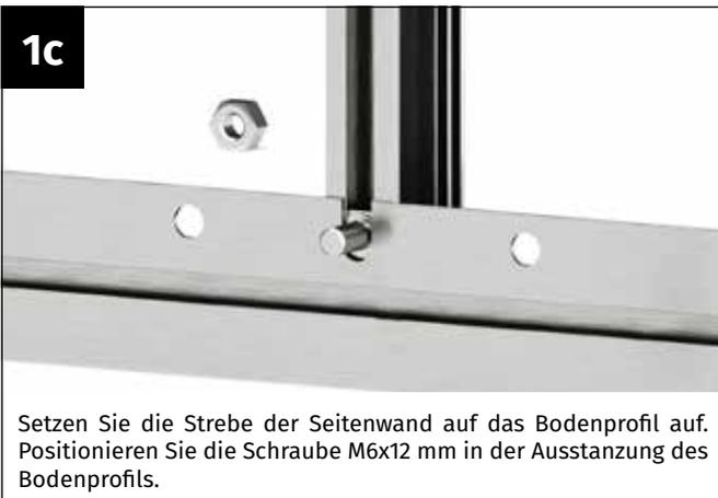
Setzen Sie die Strebe der Seitenwand auf das Bodenprofil auf. Positionieren Sie die Schraube M6x12 mm in der Ausstanzung des Bodenprofils.
