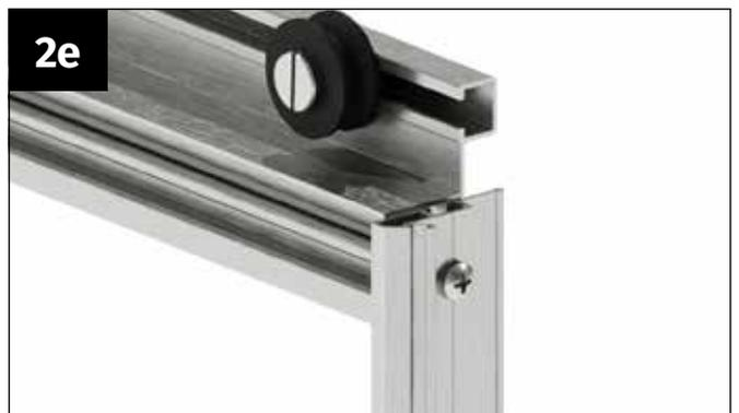
Verschrauben Sie das Türrollenprofil mit der Blechschraube 4,2 x 22 mm fest mit dem seitlichen Türprofil.
