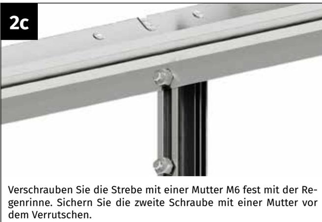
Verschrauben Sie die Strebe mit einer Mutter M6 fest mit der Regenrinne. Sichern Sie die zweite Schraube mit einer Mutter vor dem Verrutschen.
