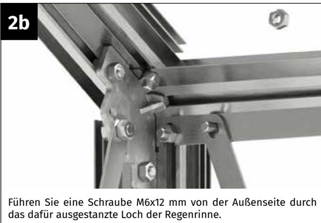
Führen Sie eine Schraube M6x12 mm von der Außenseite durch das dafür ausgestanzte Loch der Regenrinne.
