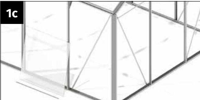
Führen Sie eine Glasplatte von oben in die Seitenwand ein. Es kann dafür notwendig sein, den Windverband an der Innenseite nochmals zu lockern, um das Gewächshaus exakt im Lot ausrichten zu können.
