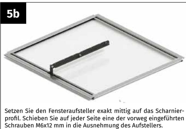
Setzen Sie den Fensteraufsteller exakt mittig auf das Scharnierprofil. Schieben Sie auf jeder Seite eine der vorweg eingeführten Schrauben M6x12 mm in die Ausnehmung des Aufstellers.
