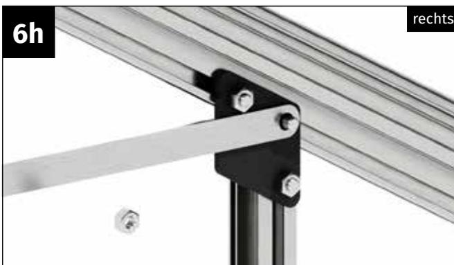
Setzen Sie den Windverband so auf die Schraube, dass diese durch das Loch des Windverbandes hindurchragt.
