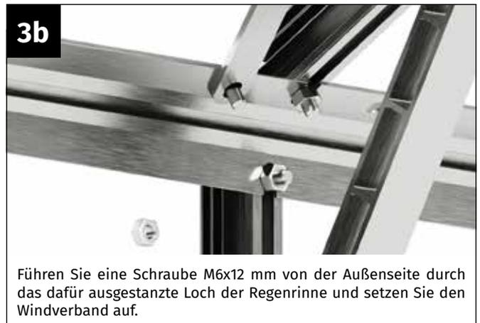
Führen Sie eine Schraube M6x12 mm von der Außenseite durch das dafür ausgestanzte Loch der Regenrinne und setzen Sie den Windverband auf.
