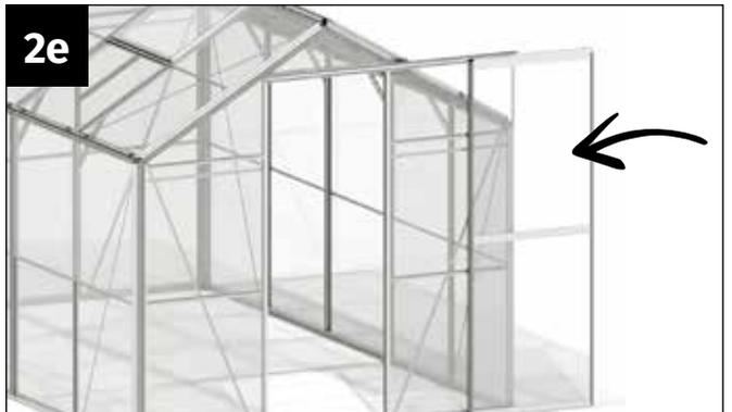
Nehmen Sie den vorbereiteten Türflügel zur Hand – dieser wird nun von der Seite her in die Frontwand eingesetzt.
