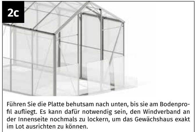
Führen Sie die Platte behutsam nach unten, bis sie am Bodenprofil aufliegt. Es kann dafür notwendig sein, den Windverband an der Innenseite nochmals zu lockern, um das Gewächshaus exakt im Lot ausrichten zu können.
