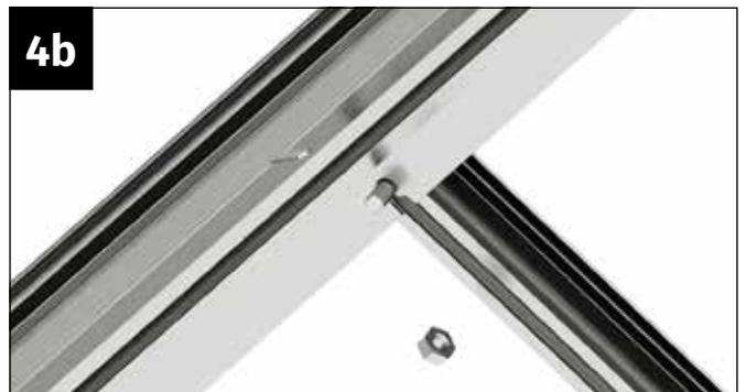
Führen Sie die Schrauben M6x12 mm an der Oberseite in den Schraubkanal der Dachstrebe ein. Positionieren Sie eine der Schrauben in der Ausstanzung des Firstprofils.
