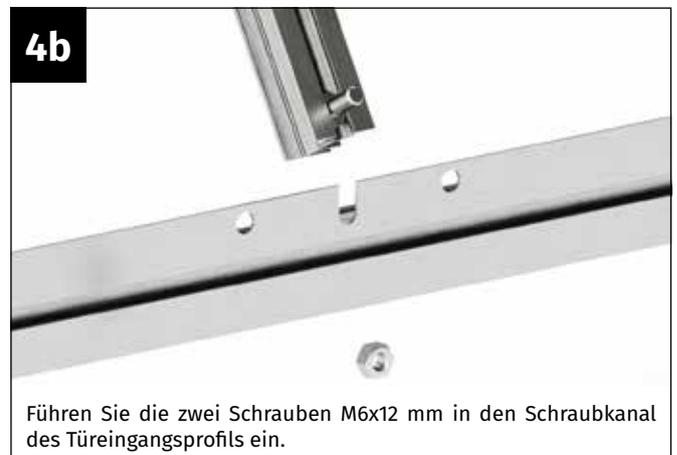
Führen Sie die zwei Schrauben M6x12 mm in den Schraubkanal des Türeingangsprofils ein.
