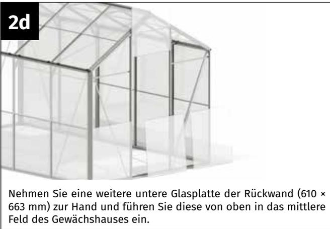
Nehmen Sie eine weitere untere Glasplatte der Rückwand (610 × 663 mm) zur Hand und führen Sie diese von oben in das mittlere Feld des Gewächshauses ein.
