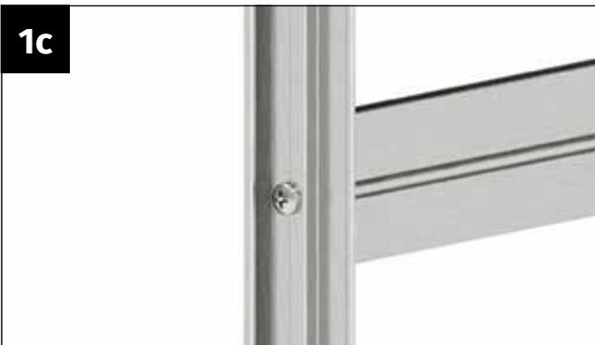
Verschrauben Sie das seitliche Türprofil mit der Blechschraube 4,2 x 22 mm fest mit der Türsprosse.
