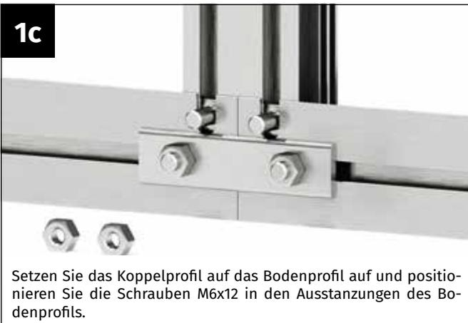
Setzen Sie das Koppelprofil auf das Bodenprofil auf und positionieren Sie die Schrauben M6x12 in den Ausstanzungen des Bodenprofils.
