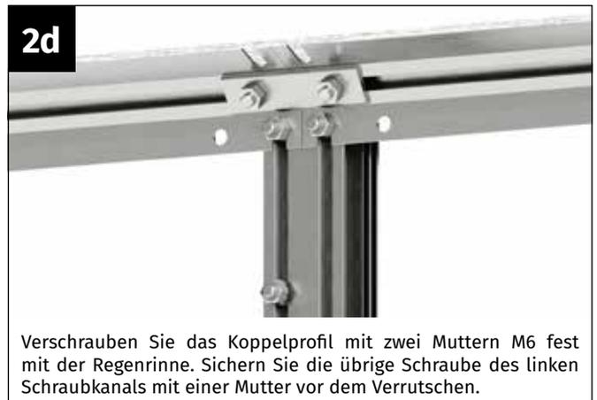
Verschrauben Sie das Koppelprofil mit zwei Muttern M6 fest mit der Regenrinne. Sichern Sie die übrige Schraube des linken Schraubkanals mit einer Mutter vor dem Verrutschen.
