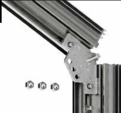
Setzen Sie den Eckverbinder aus Zinkdruckguss so auf, dass die beiden Schrauben M6x12 durch die vorgesehenen Löcher ragen.
