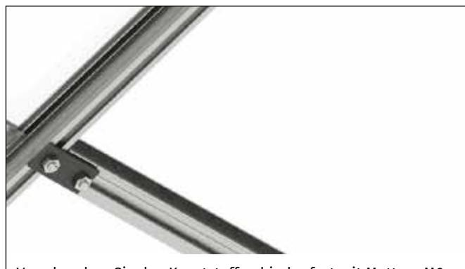
Verschrauben Sie den Kunststoffverbinder fest mit Muttern M6. Achten Sie darauf, dass sich dabei die Rhombusschraube im Schraubkanal der Dachstrebe verkeilt!
