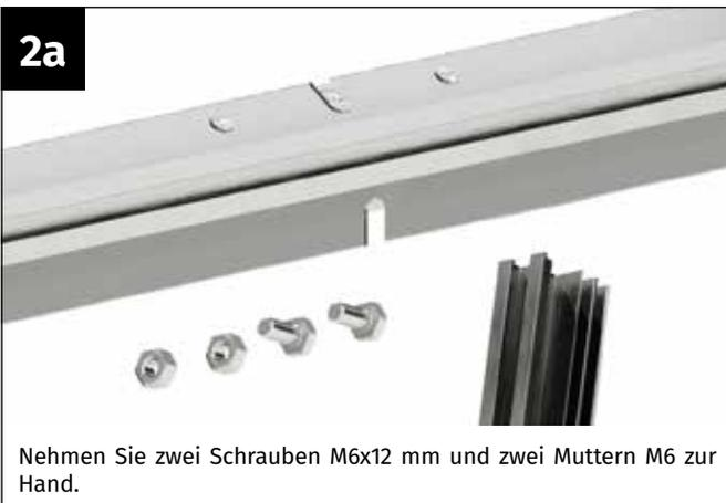
Nehmen Sie zwei Schrauben M6x12 mm und zwei Muttern M6 zur Hand.
