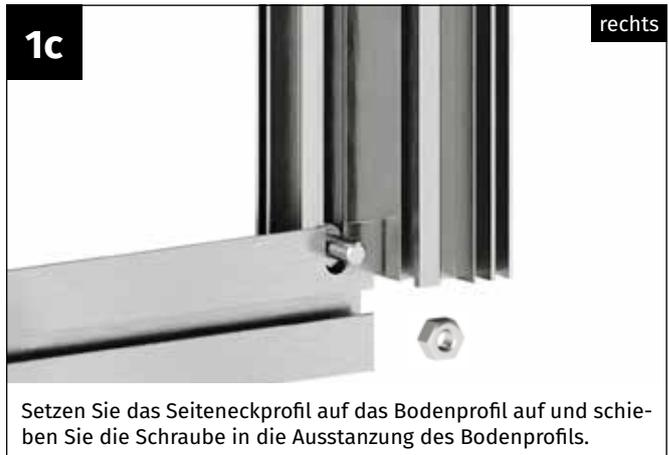
Setzen Sie das Seiteneckprofil auf das Bodenprofil auf und schieben Sie die Schraube in die Ausstanzung des Bodenprofils.
