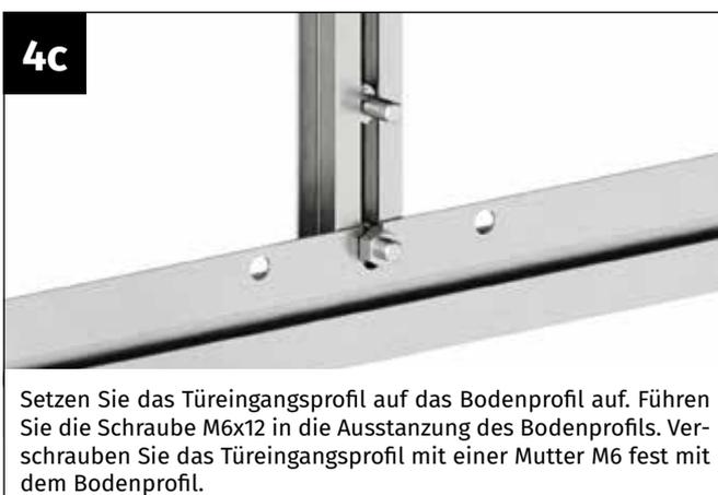
Setzen Sie das Türeingangsprofil auf das Bodenprofil auf. Führen Sie die Schraube M6x12 in die Ausstanzung des Bodenprofils. Verschrauben Sie das Türeingangsprofil mit einer Mutter M6 fest mit dem Bodenprofil.
