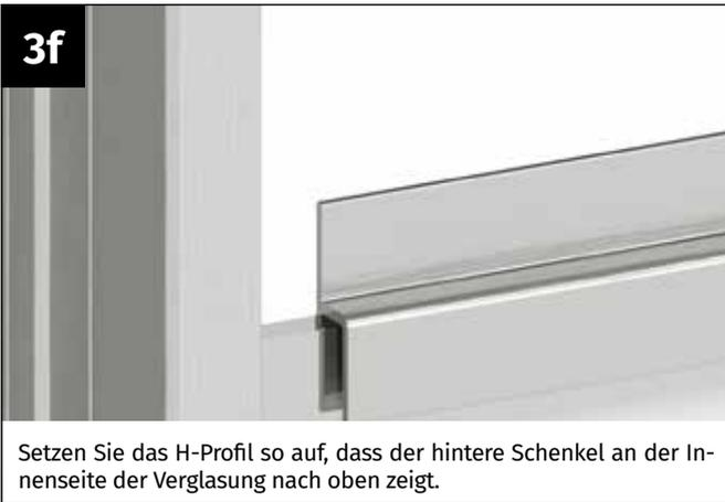
Setzen Sie das H-Profil so auf, dass der hintere Schenkel an der Innenseite der Verglasung nach oben zeigt.
