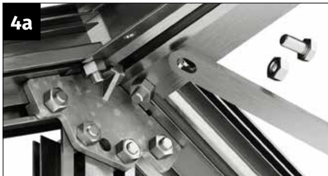
Positionieren Sie die obere Seite des Windverbandes so, dass die Ausstanzung des Windverbandes über der Ausstanzung des Firsts liegt.
