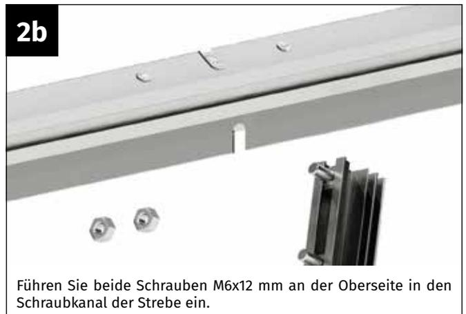
Führen Sie beide Schrauben M6x12 mm an der Oberseite in den Schraubkanal der Strebe ein.
