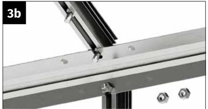
Führen Sie die Schrauben M6x12 mm in den Schraubkanal der Dachstrebe ein. Setzen Sie diese auf die Regenrinne auf. Positionieren Sie eine Schraube in der Ausstanzung der Regenrinne.
