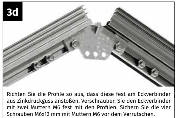
Richten Sie die Profile so aus, dass diese fest am Eckverbinder aus Zinkdruckguss anstoßen. Verschrauben Sie den Eckverbinder mit zwei Muttern M6 fest mit den Profilen. Sichern Sie die vier Schrauben M6x12 mm mit Muttern M6 vor dem Verrutschen.
