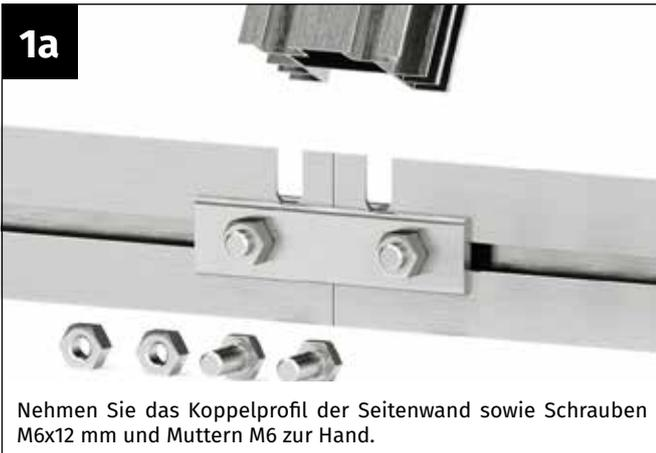
Nehmen Sie das Koppelprofil der Seitenwand sowie Schrauben M6x12 mm und Muttern M6 zur Hand.
