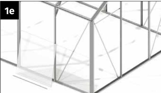
Führen Sie die Platte behutsam nach unten, bis sie am Bodenprofil aufliegt.
