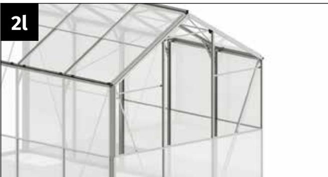
Führen Sie nun in jedes der drei Felder eine Glasplatte 610 × 630 mm ein. Diese werden so positioniert, dass sie bündig an den H-Profilen aufliegen.
