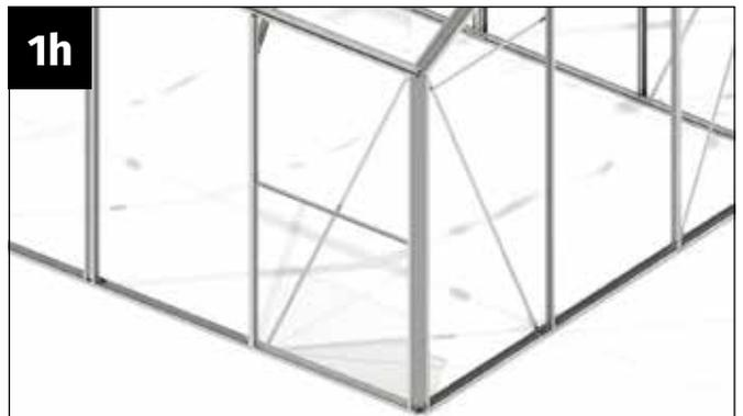
Nehmen Sie die zweite Glasplatte zur Hand und führen Sie diese von oben in die Seitenwand ein.
