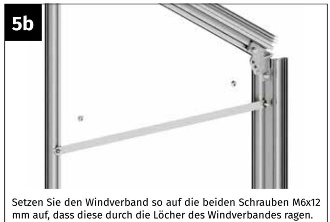
Setzen Sie den Windverband so auf die beiden Schrauben M6x12 mm auf, dass diese durch die Löcher des Windverbandes ragen.
