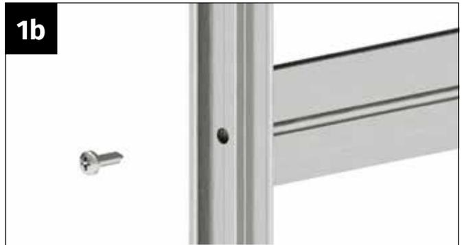
Positionieren Sie das Türprofil mitte so am seitlichen Türprofil, dass das ausgestanzte mittlere Loch genau über dem Schraubkegel der Türsprosse liegt.
