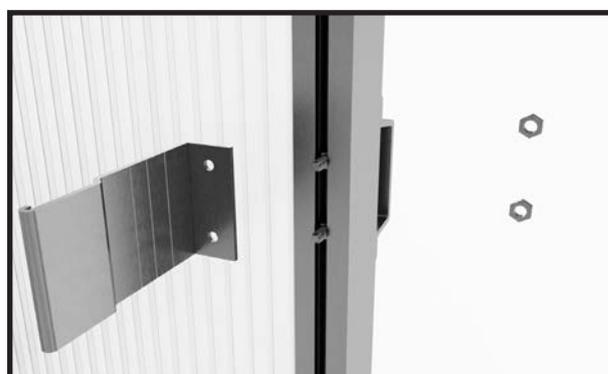
Setzen Sie zwei Rhombusschrauben in den Schraubkanal des Türprofils ein.
