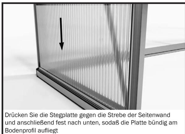
Drücken Sie die Stegplatte gegen die Strebe der Seitenwand und anschließend fest nach unten, sodaß die Platte bündig am Bodenprofil aufliegt
