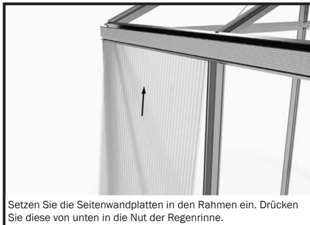
Setzen Sie die Seitenwandplatten in den Rahmen ein. Drücken Sie diese von unten in die Nut der Regenrinne.
