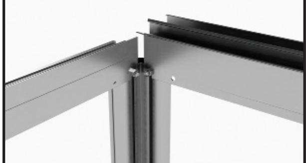
Verschrauben Sie die Querstrebe mit einer Flanschnmutter M6 fest mit dem Seiteneckprofil.
